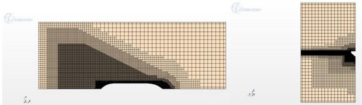
a) domena diskretizirana finom mrežom: tlocrt (lijevo) i nacrt (desno)
