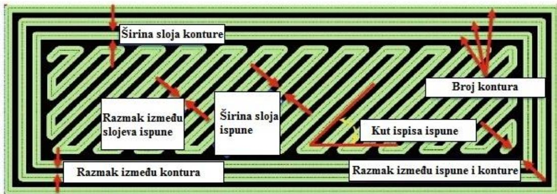
Slika 2.4. Primjer strukture sloja kod postupka FDM [10]
