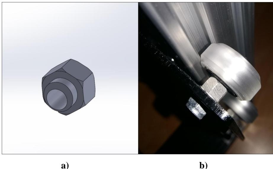
**Slika 3.9. Ekscentrični odstojnik: a) 3D model ekscentričnog odstojnika, b) prikaz montaže na stroju**
