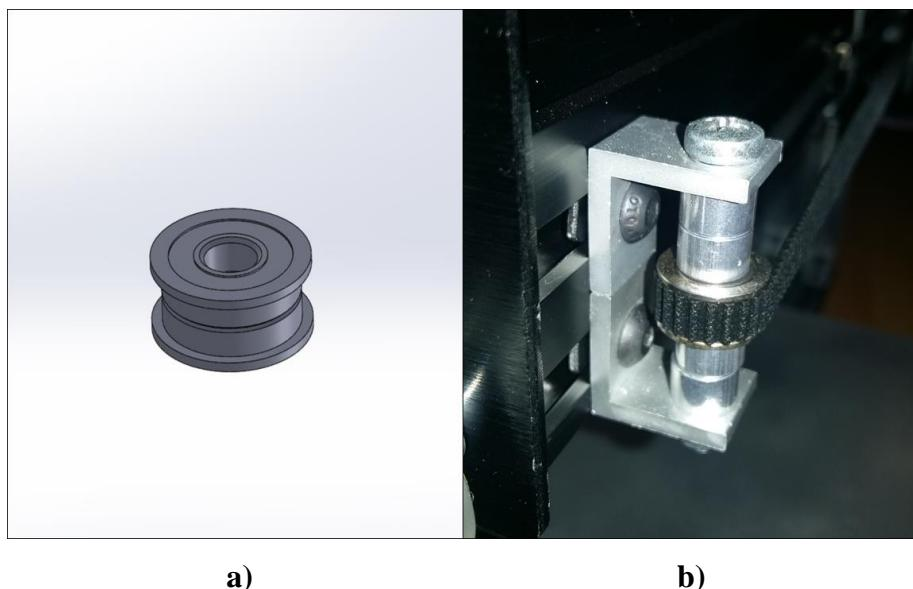
**Slika 3.3. Gonjena remenica za pogon po x osi: a) 3D model gonjene remenice, b) prikaz montaže na stroju**
