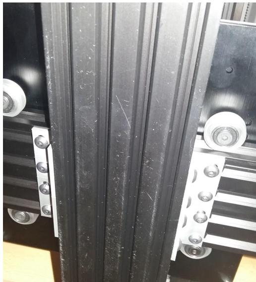
**Slika 5.3. Prikaz montaže cijelog sustava za gibanje u smjeru y osi**
