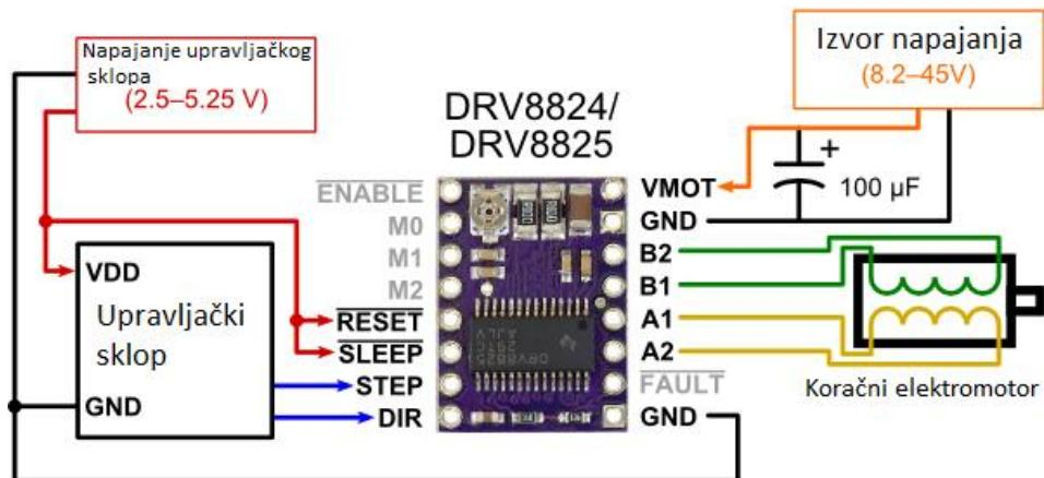
Slika 3.16. Shema upravljačke pločice koračnog elektromotora
