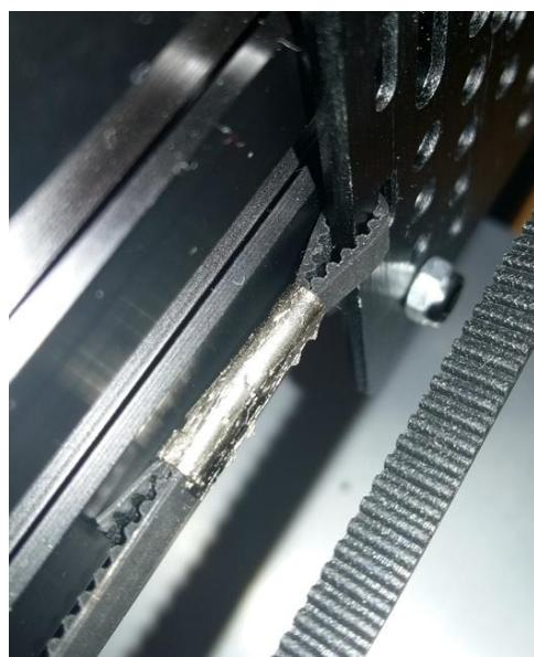
**Slika 3.5. Prikaz remenskog zatvarača**
