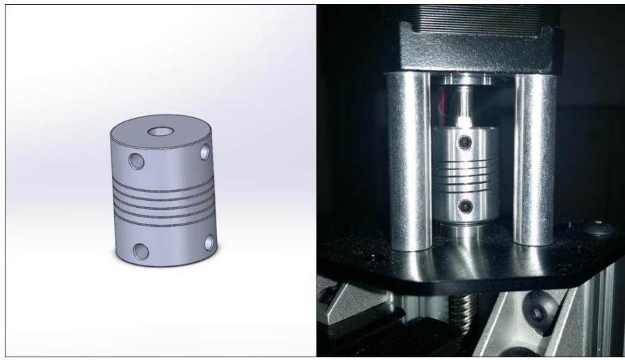
Slika 3.6. Elastična spojka za prijenos gibanja navojnim vretenom: a) 3D model spojke, b) prikaz montaže na stroju
