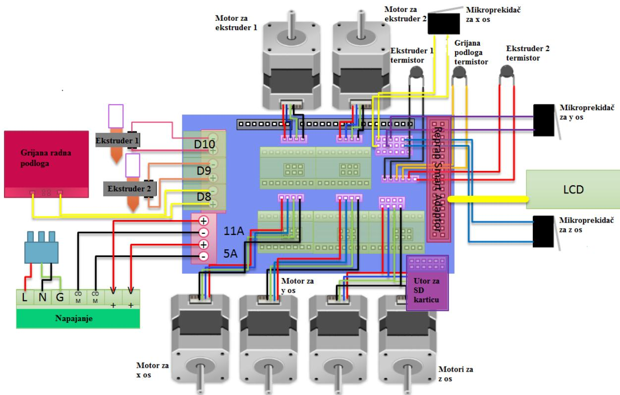
Slika 3.24. Dijagram spajanja upravljačke ploče RAMPS 1.4 [42]
