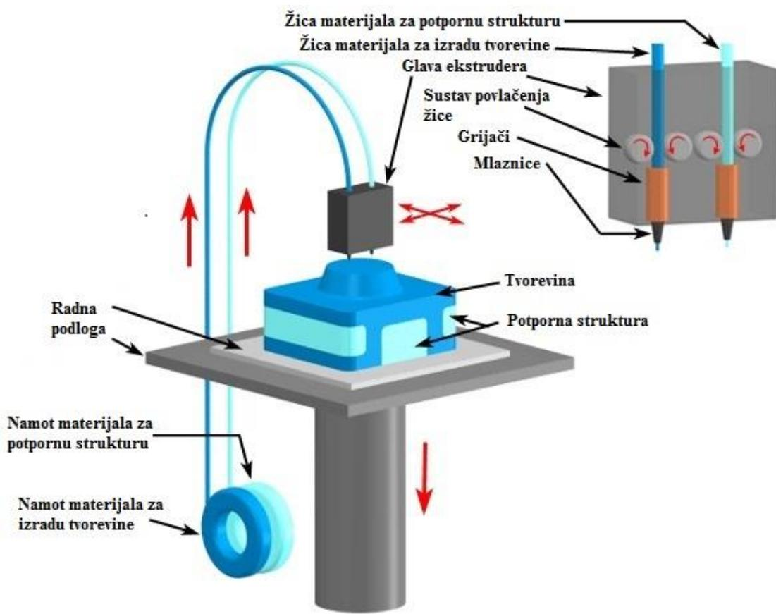
Slika 2.3. Postupak taložnog očvršćivanja – FDM [8]
