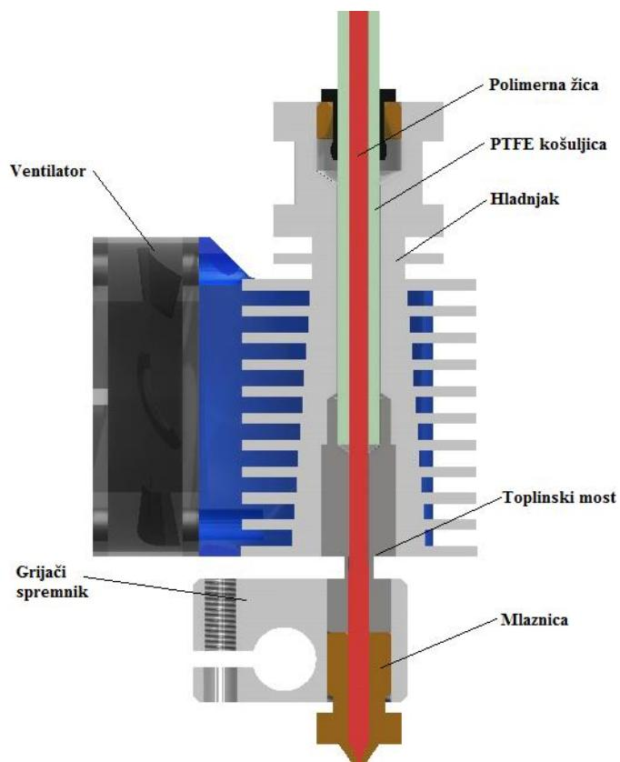
**Slika 3.14. Presjek 3D modela *E3D-v6* sustava [34]**
