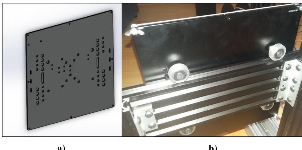
**Slika 3.10. Donja ploča radne podloge: a) 3D model donje ploče, b) prikaz montaže na stroj**
