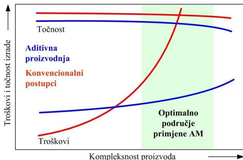
Slika 2.2. Opravdanost primjene postupaka aditivne proizvodnje [6]
