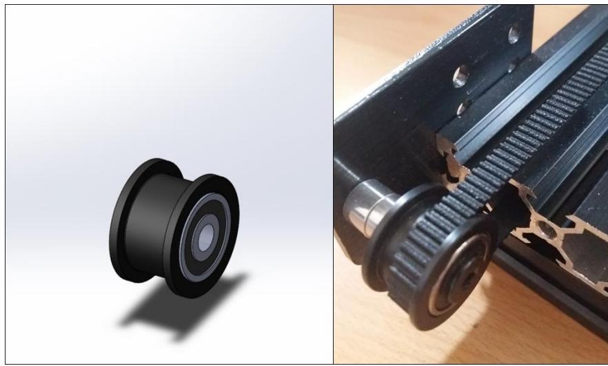
**Slika 3.4. Gonjena remenica za pogon po y osi: a) 3D model gonjene remenice, b) prikaz montaže na stroju**
