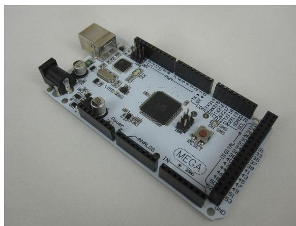
**Slika 3.22. Mikroupravljački sklop Taurino Power [41]**
