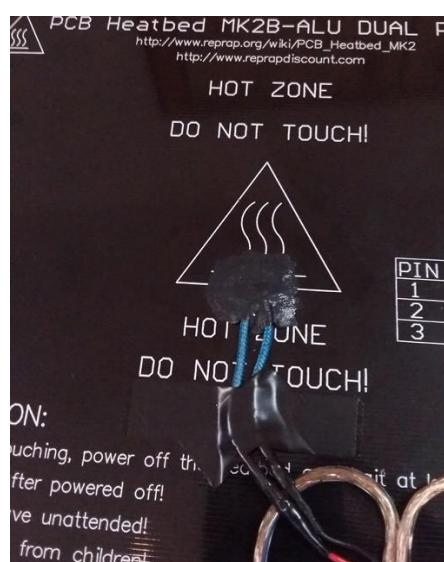
Slika 3.21. Montaža termistora na grijanoj radnoj podlozi
