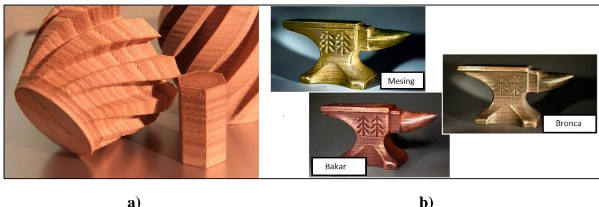
**Slika 2.12. Tvorevine izrađene od kompozitnih materijala: a) kompozit PLA/drvo, b) kompozit PLA/metal [14]**
