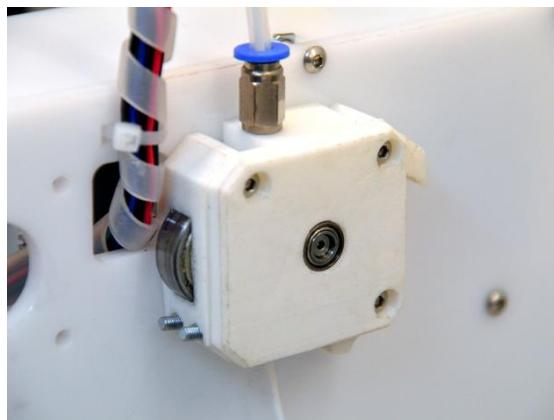
Slika 3.12. *Bowden* izvedba ekstrudera - mehanički sustav provlačenja žice [33]
