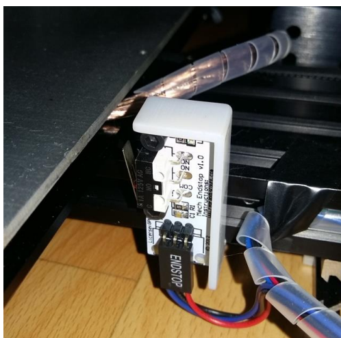
Slika 3.17. Mehanički mikroprekidač postavljen na y osi
