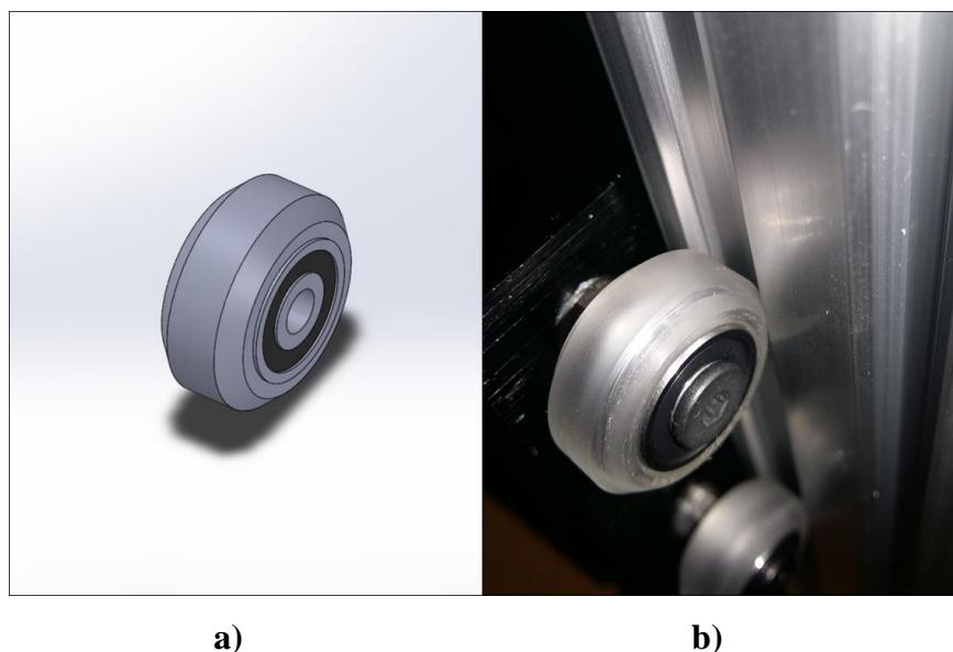
**Slika 3.8. Kotačić za vođenje: a) 3D model kotačića, b) prikaz montaže na stroju**
