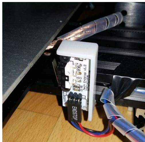
**Slika 3.17. Mehanički mikroprekidač postavljen na y osi**
