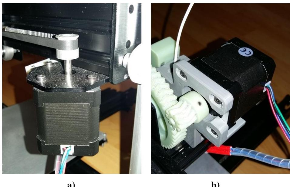
**Slika 3.15. Primjer montaže koračnih elektromotora: a) za ostvarivanje gibanja po x osi, b) za dobavljanje žice u ekstruder**
