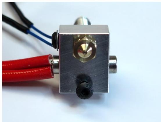
Slika 3.18. Montaža grijajućeg elementa u grijajućem spremniku *E3D-v6* sustava [38]
