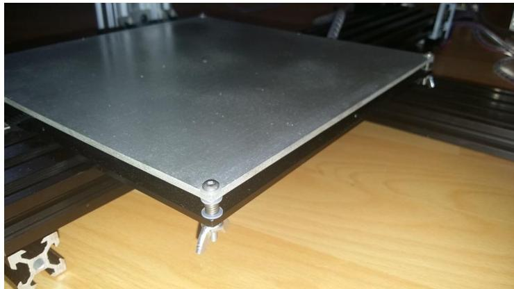
Slika 3.11. Gornja ploča radne podloge s oprugom i vijkom za namještanje visine
