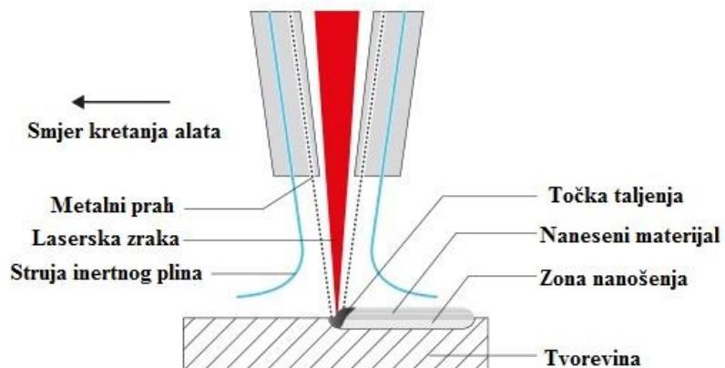
**Slika 2.22. Postupak izravnog taloženja metala tvrtke DMG MORI [24]**
