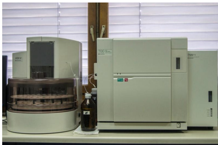
Slika 22. Uređaj za mjerenje vrijednosti NPOC-a (TOC-a)
