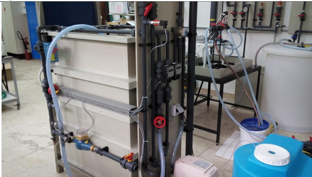
Slika 11. Laboratorijski uređaj sa UF/MF vakuumskom membranom
