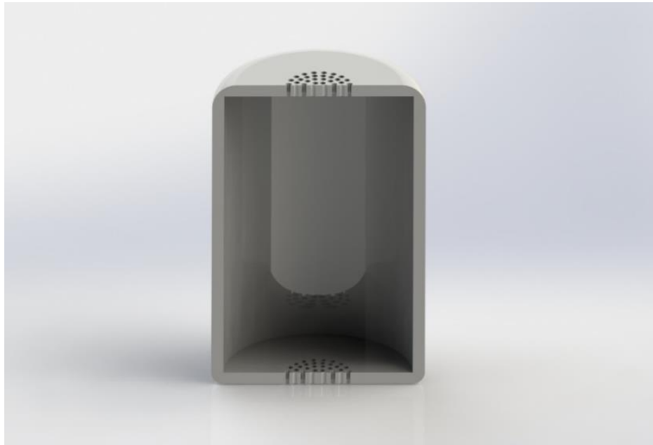
Slika 47. Presjek filter ampule
