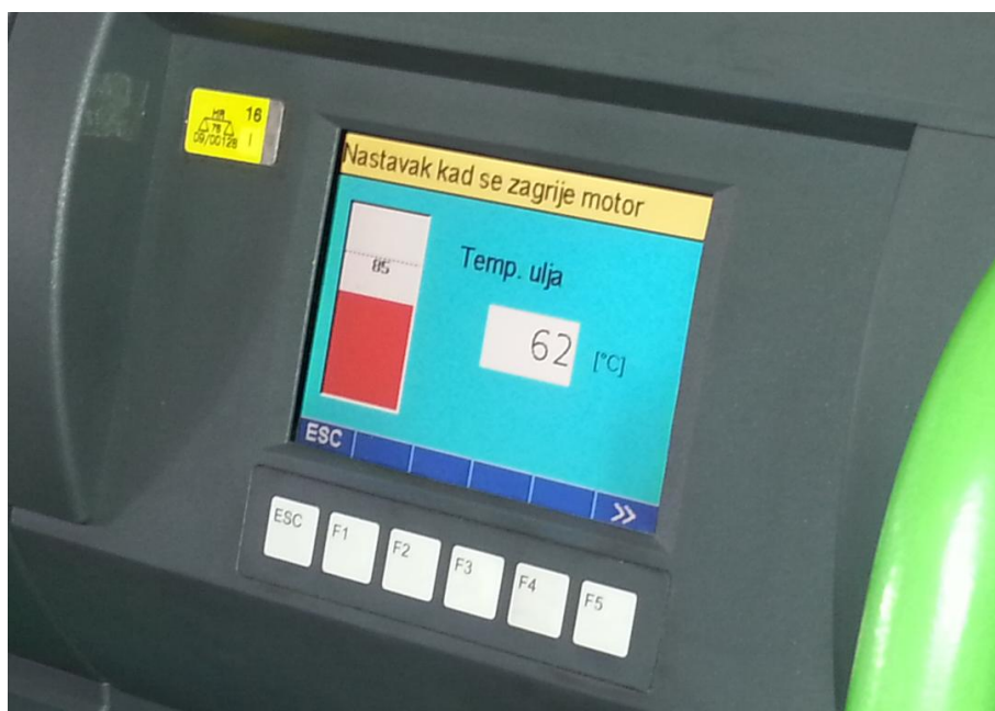
Slika 29. Zagrijavanje motora, odnosno katalizatora na radnu temperaturu
