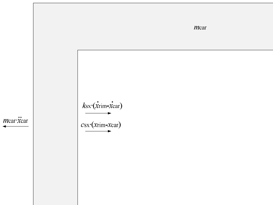
Slika 29. Vozilo oslobođeno veza s ucrtanim reakcijama i inercijskim silama u horizontalnom smjeru
