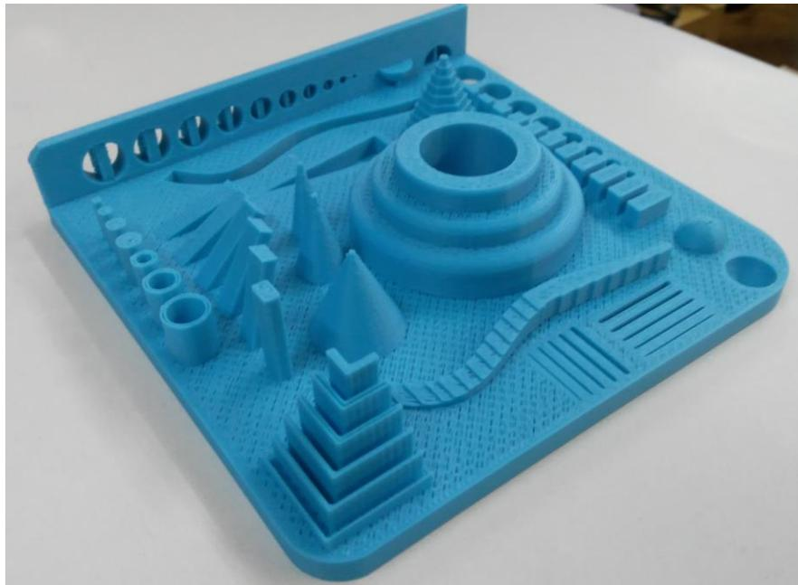
Slika 5.6. Ispitna pločica 1 s potpornim strukturama
