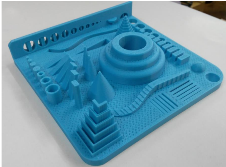
Slika 5.6. Ispitna pločica 1 s potpornim strukturama
