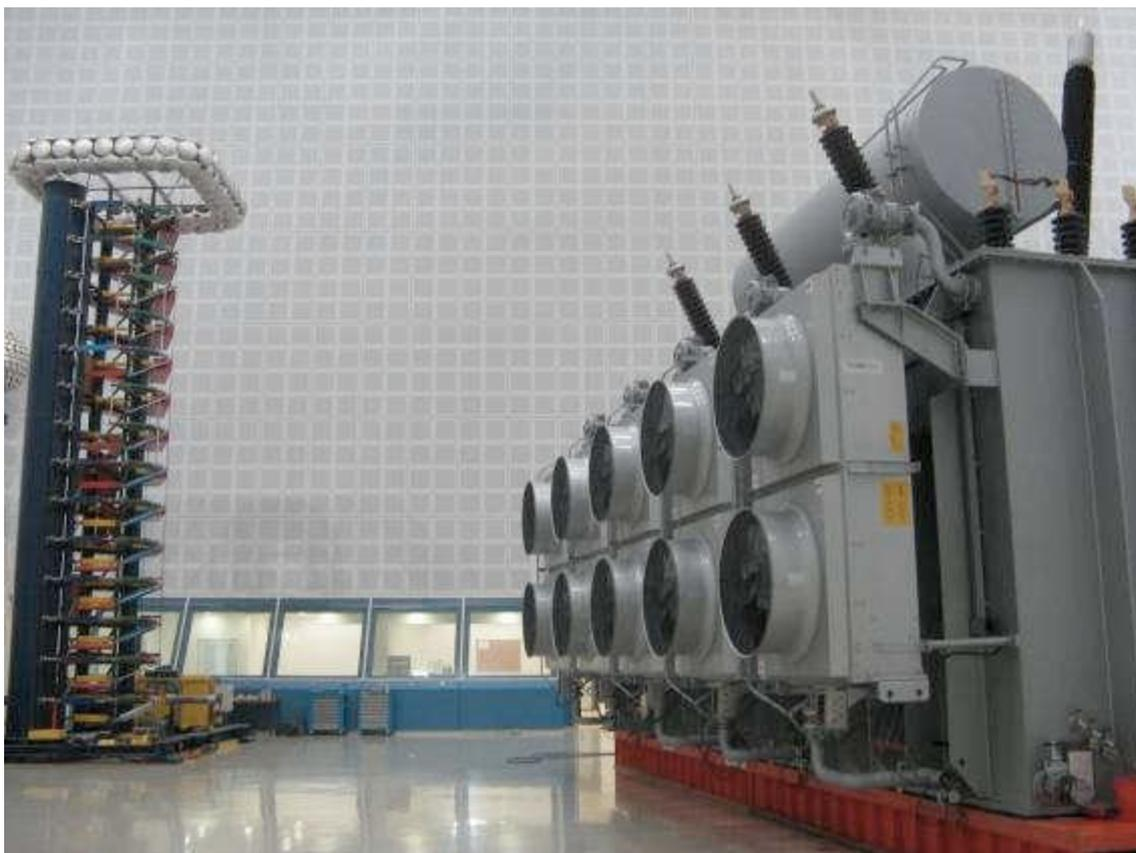
**Slika 26. Prvo ispitivanje transformatora [28]**
