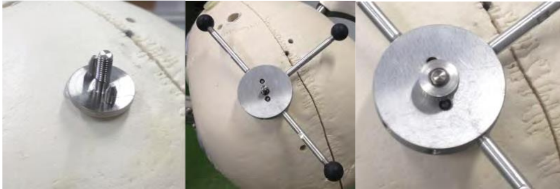
Slika 10 Sustav za lokalizaciju (sustav markera) za stereotaktički sustav RONNA; Lijevo: titanski vijak učvršćen za glavu fantoma; Sredina: Sustav markera postavljen na titanski vijak; Desno: Sustav markera kruto povezan za vijak putem matice [64].
