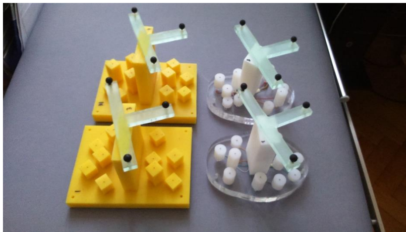
Slika 25 Fantom za mjerenje točnosti sustava RONNA s metalnim kuglicama kao ciljnim točkama.
