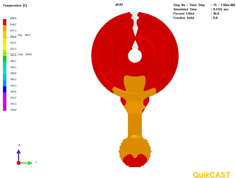
Slika 8.7, Rezultati simulacije uljevnog sustava s jednim ušćem (bez preljeva), t=0,4122 s
