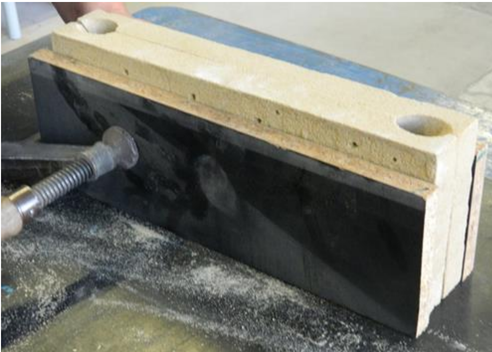
Slika 6.13. Kalup spreman za ulijevanje
