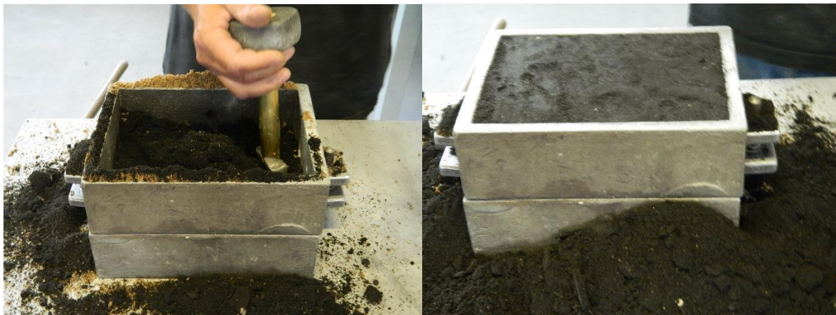
Slika 6.16. Sabijanje kalupne mješavine (lijevo), sabijena mješavina (desno)
