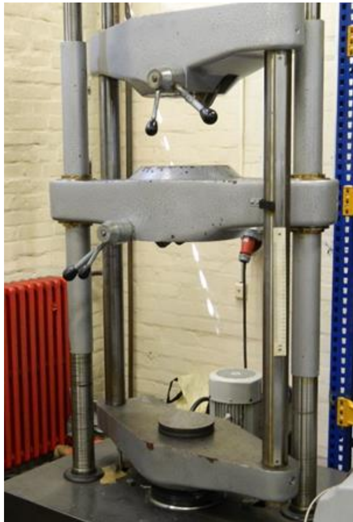
Slika 6.33. Kidalica „VEB WPM“
