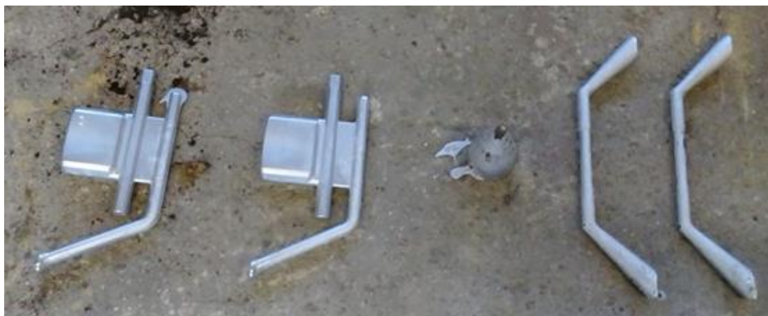
Slika 6.26. Gotovi odljevci nakon vađenja iz kalupa
