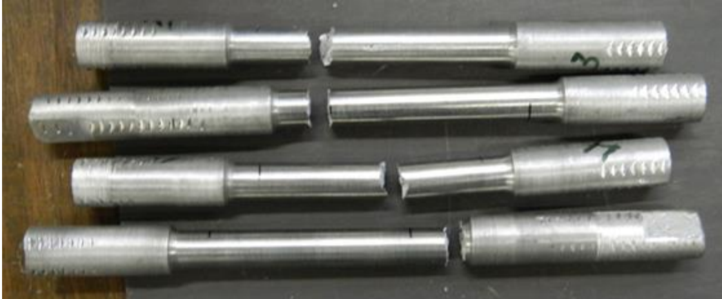
Slika 6.44. Epruvete nakon kidanja
