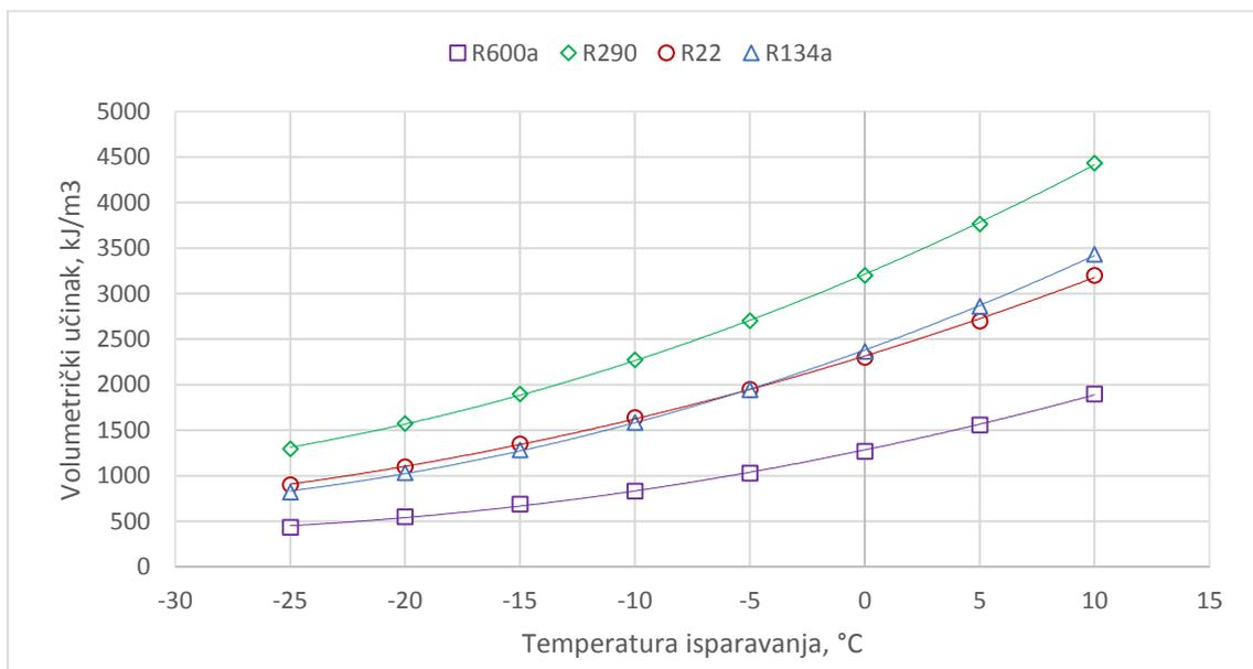
Slika 2-1. Volumetrički rashladni učinak radnih tvari kao funkcija temperature isparavanja, [3]
