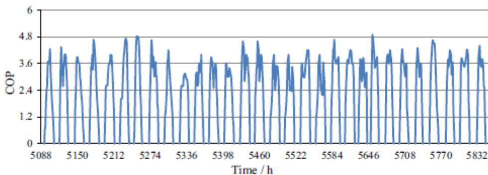
Slika 3-9. Izmjerene vrijednosti COP-a geotermalne dizalice topline, [5]
