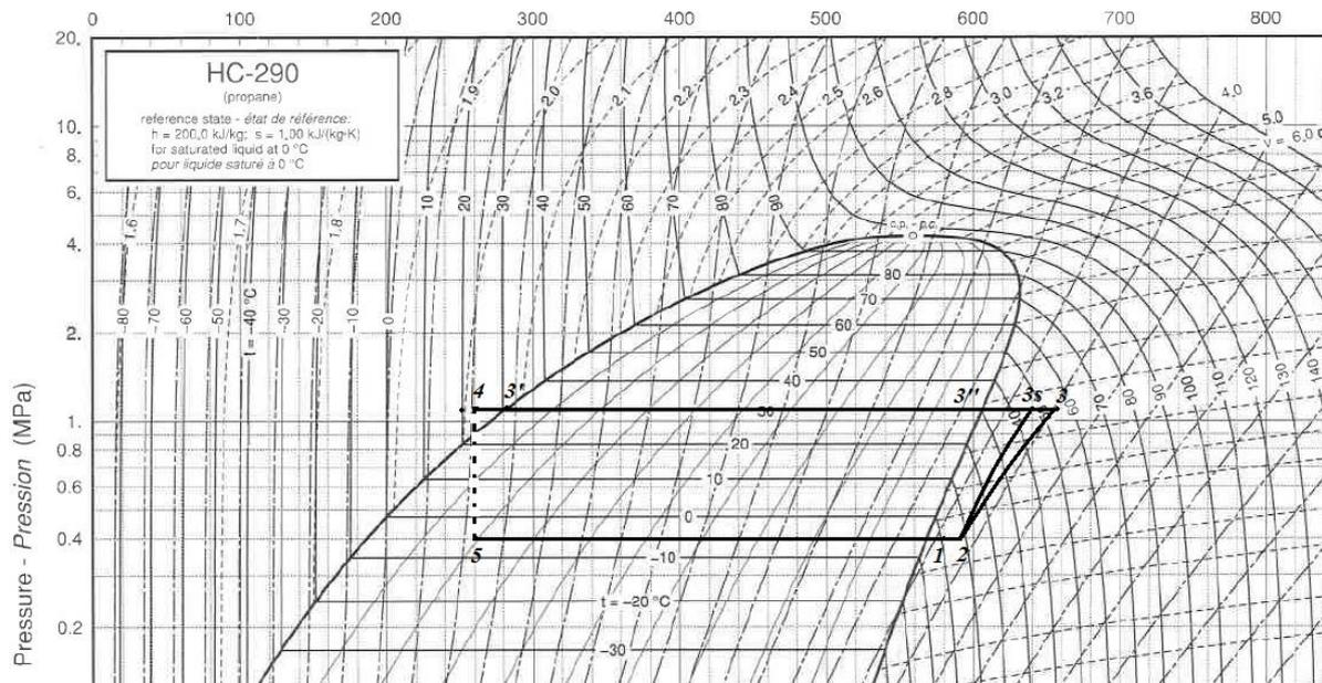
Slika 5-2. log-p-h dijagram s karakterističnim radnim točkama procesa
