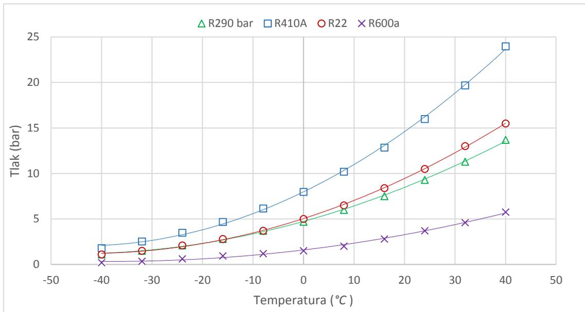
Slika 2-3. Tlakovi zasićenja za pojedine radne tvari, [3]
