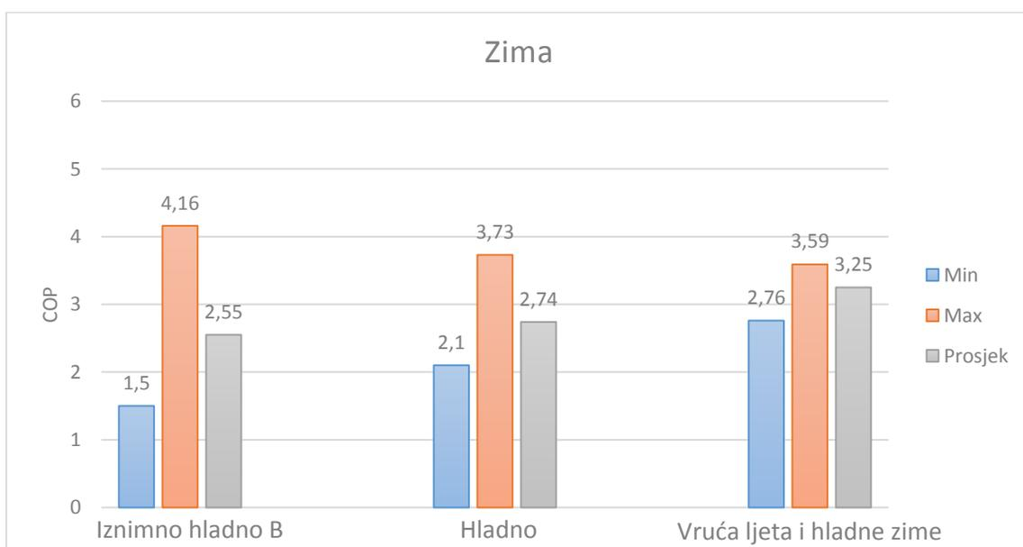
Slika 3-6. Vrijednosti COP-a geotermalnih dizalica topline za vrijeme zime, [5]
