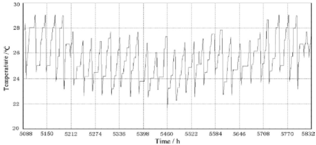
Slika 3-10. Simulirane vrijednosti izlazne temperature bušotinskog medija, [5]
