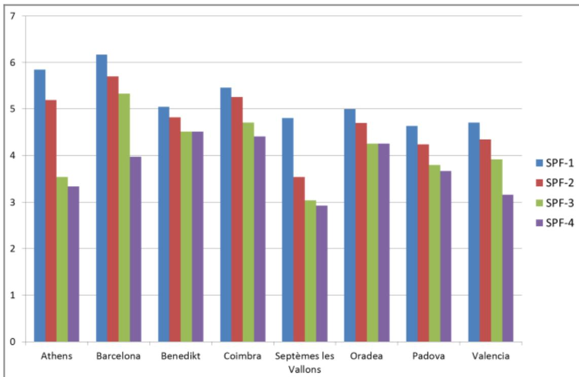
Slika 3-3. Godišnji toplinski množitelji (SPF) izračunati iz podataka dobivenih pomoću sustava za praćenje podataka za sezonu grijanja tijekom prosinca 2013, [4]
