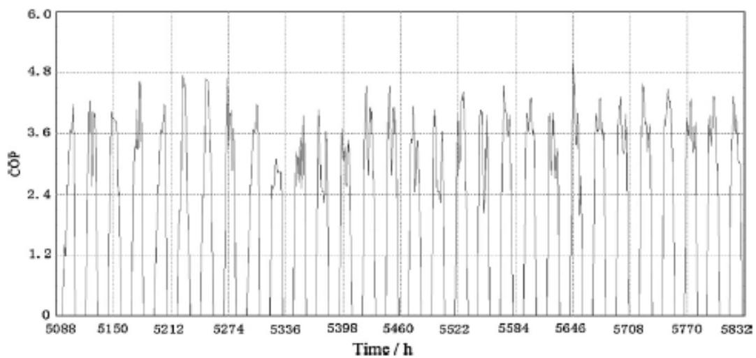
Slika 3-11. Simulirane COP vrijednosti geotermalne dizalice topline, [5]
