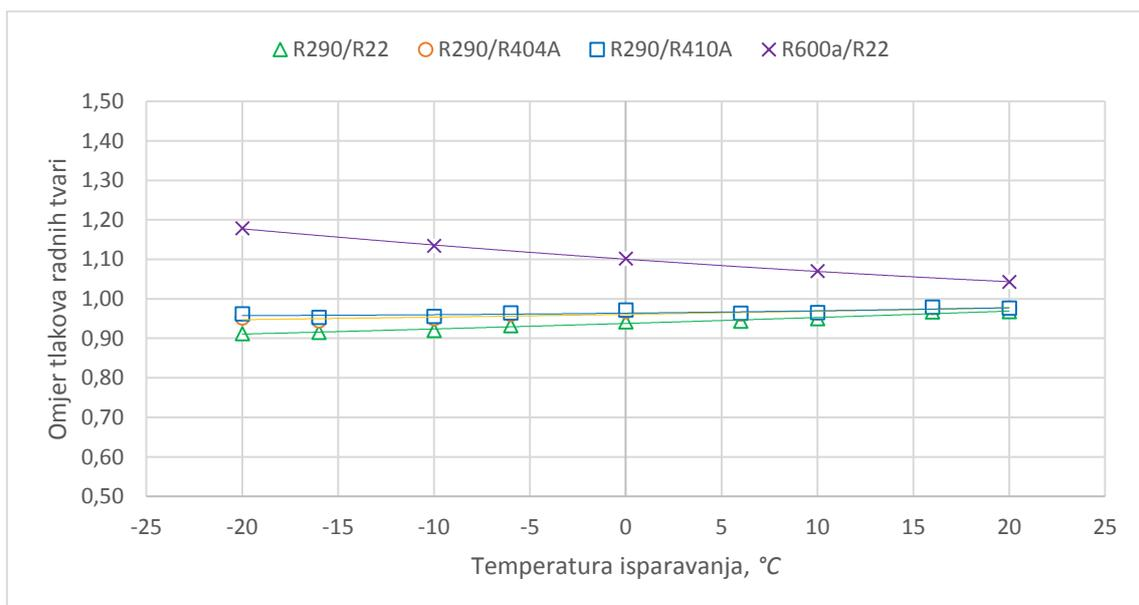
Slika 2-5. Omjeri tlakova kondenzacije i isparavanja između pojedinih radnih tvari, [3]
