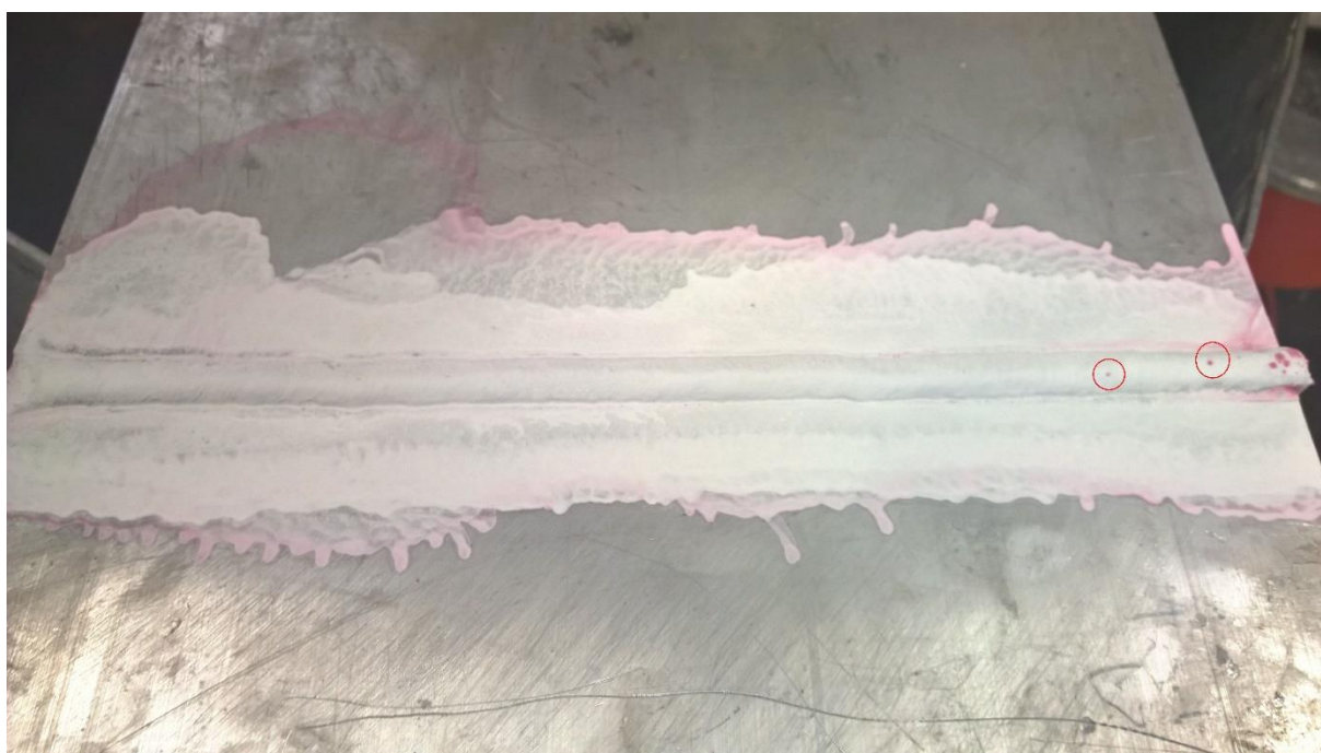
Slika 31. Korijen zavara uzorka B nakon ispitivanja penetrantima
