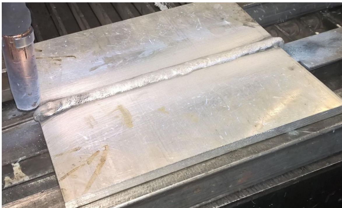
Slika 26. Lice zavara uzorka B
