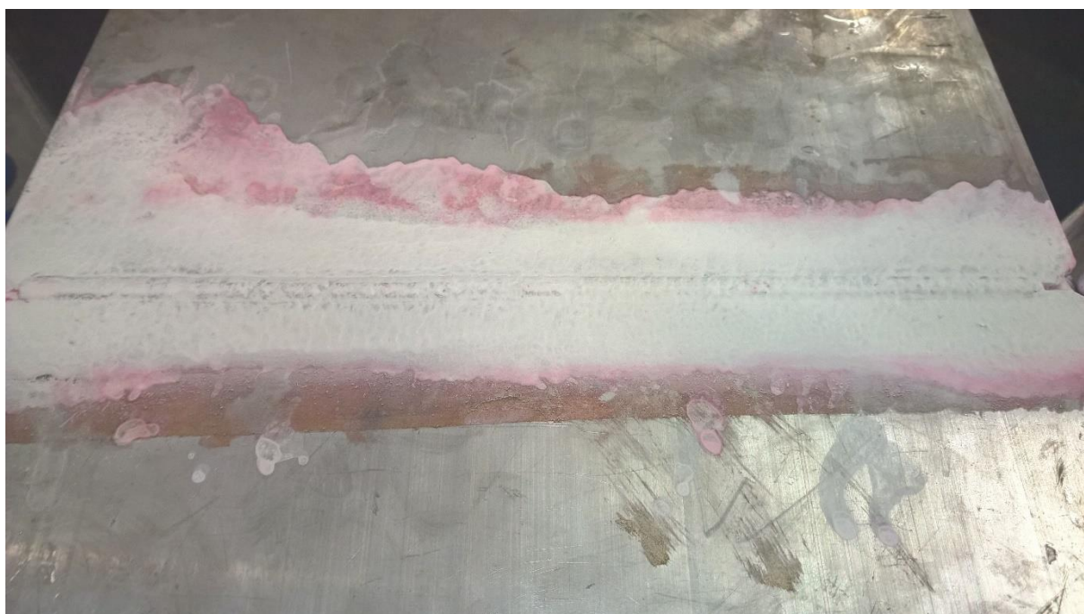
Slika 29. Korijen zavara uzorka A nakon ispitivanja penetrantima
