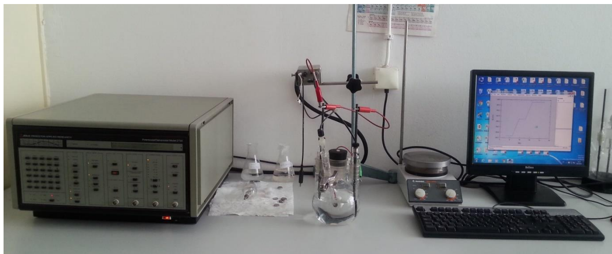
Slika 22. Ispitna oprema za elektrokemijska DC ispitivanja
