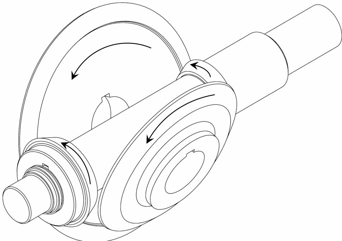
Slika 9. Koncept A – pogonski mehanizam u izometriji
