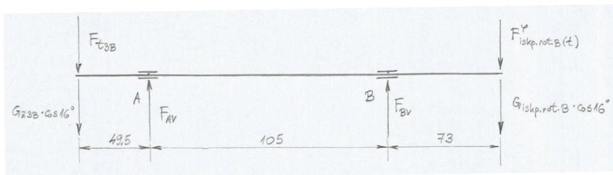
Slika 37. Vratilo B – opterećenje u vertikalnoj ravnini
