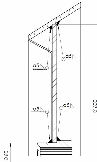
**Slika 50. Zavareni spojevi čahure, središnjeg prstena i vanjskog kola iskapačkog rotora**
