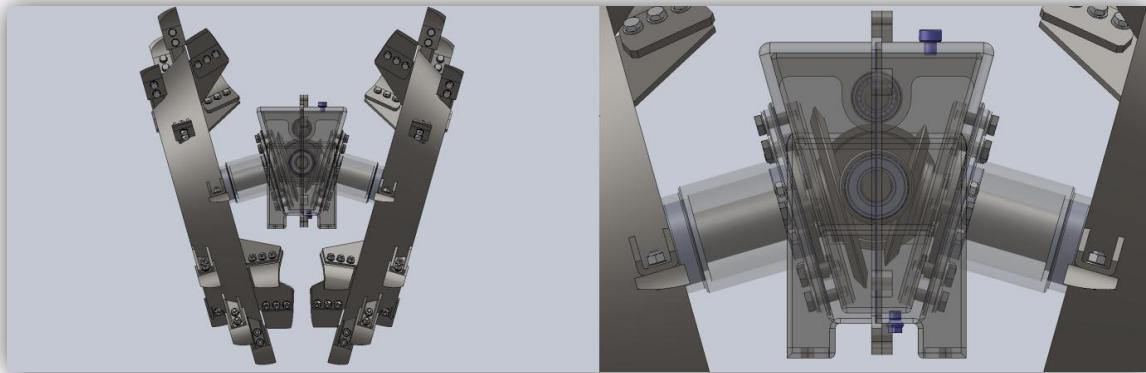
**Slika 57. Grananje snage sa centralnog prema bočnim vratilima**
