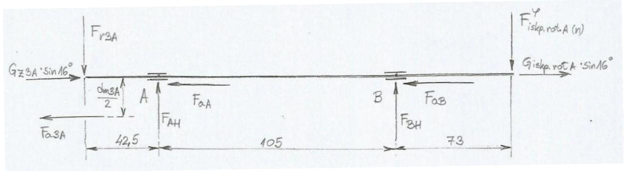
Slika 31. Vratilo A – opterećenje u horizontalnoj ravnini
