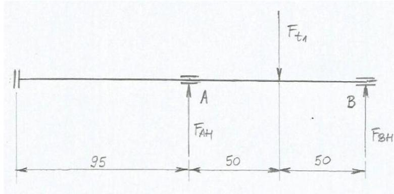
Slika 22. Vratilo 1 – opterećenje u horizontalnoj ravnini
