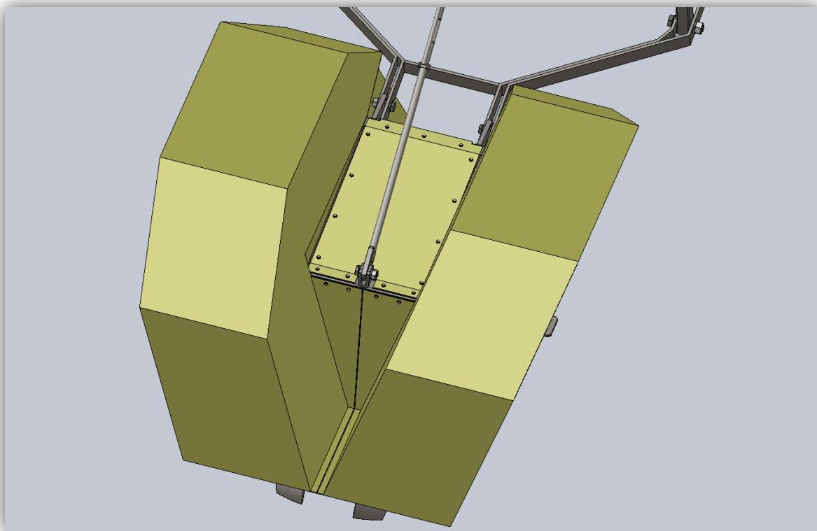
Slika 76. Prikaz cijelokupnog trodijelnog zaštitnog lima konstrukcije
