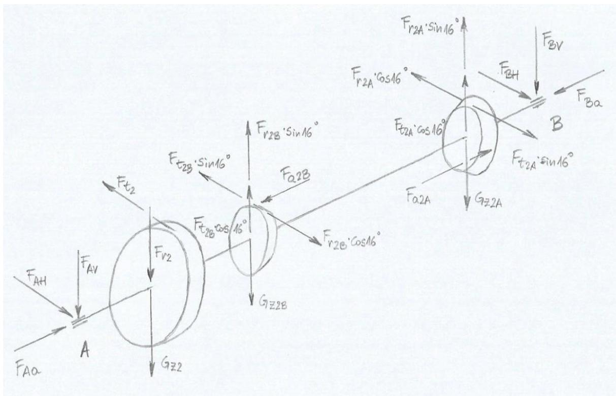
Slika 25. Vratilo 2 – opterećenje u izometriji
