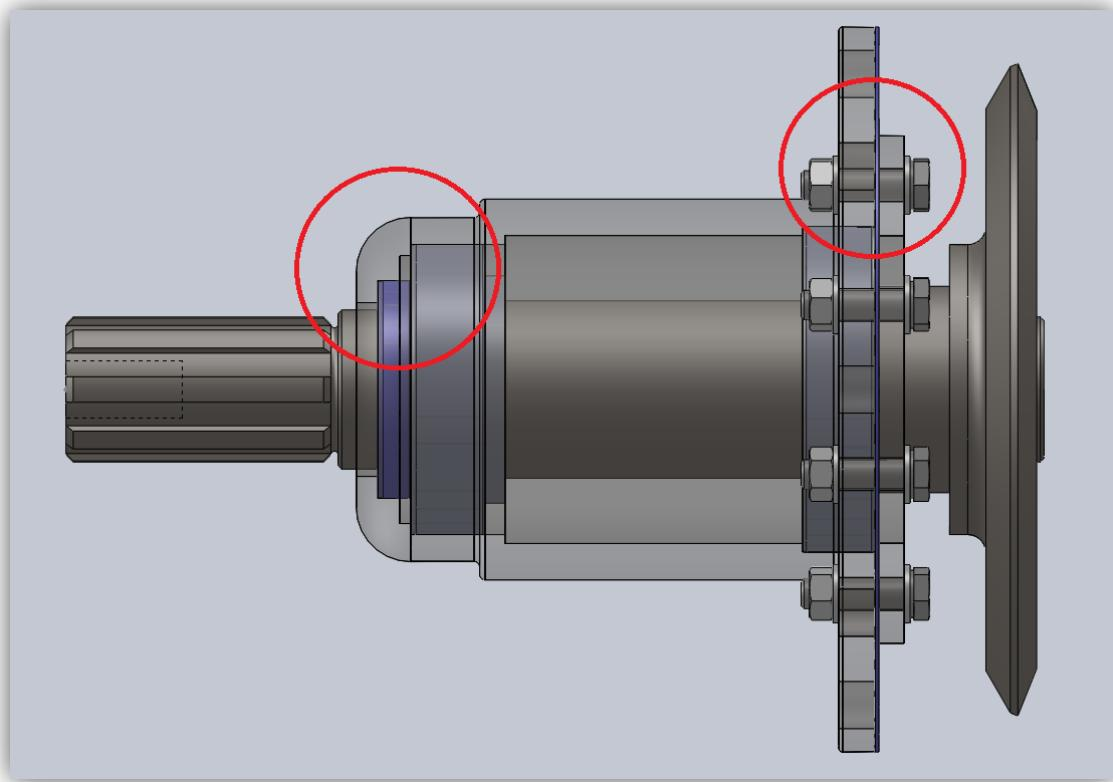
**Slika 64. Brtljenje bočnog kućišta i sprječavanje aksijalnog pomaka unutarnjim poklopcem**
