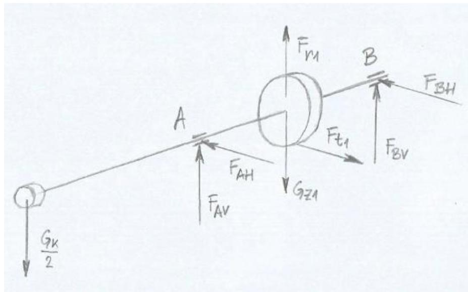
Slika 21. Vratilo 1 – opterećenje u izometriji
