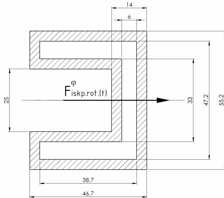
**Slika 48. Presjek zavara nosača obodnog noža za vanjsko kolo iskapačkog rotora**
