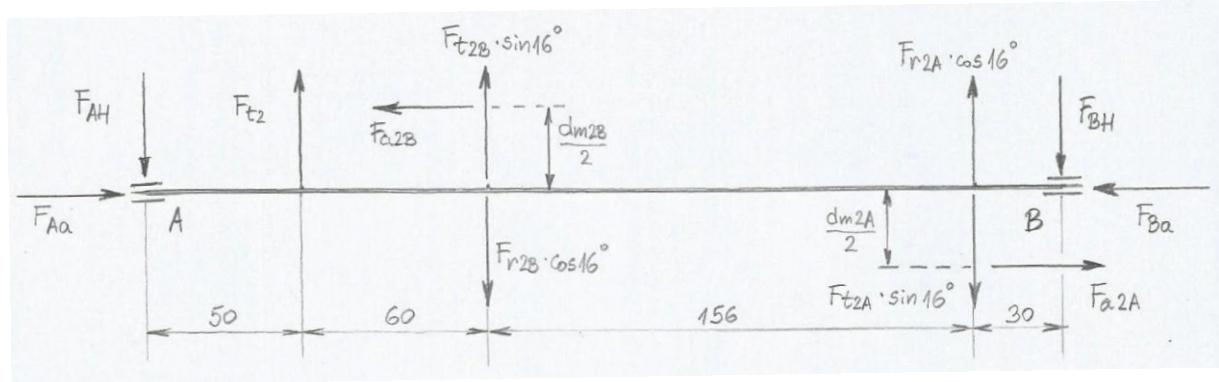
Slika 26. Vratilo 2 – opterećenje u horizontalnoj ravnini
