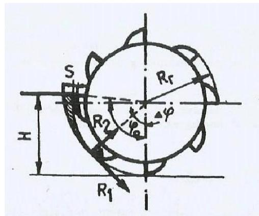
**Slika 46.** Tangencijalna sastavnica otpora rezanja jednog obodnog noža
