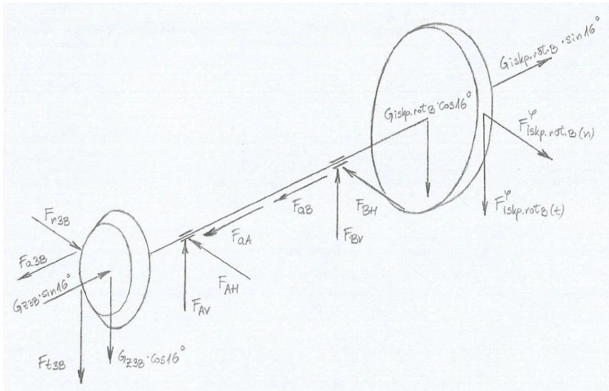
Slika 34. Vratilo B – opterećenje u izometriji
