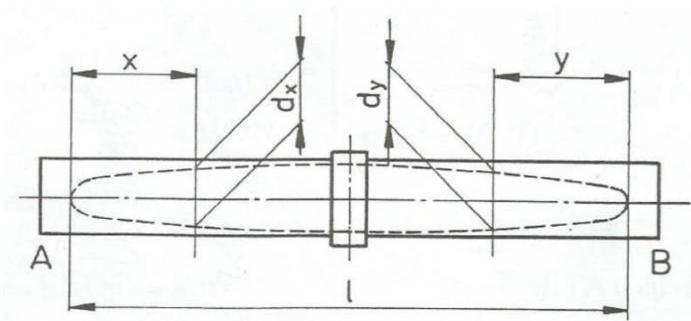
Slika 24. Vratilo 1 – smjerovi presjeka kod dimenzioniranja
