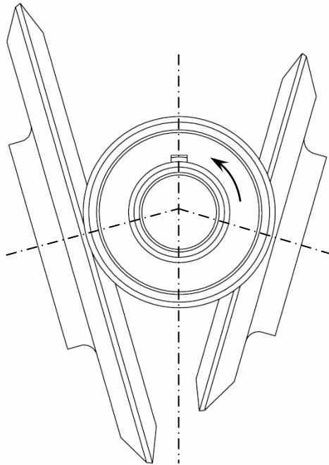
**Slika 10. Koncept A – pogonski mehanizam iz čeonog pogleda**
