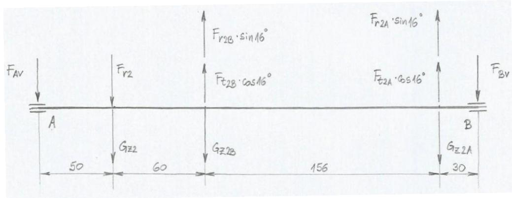
Slika 27. Vratilo 2 – opterećenje u vertikalnoj ravnini
