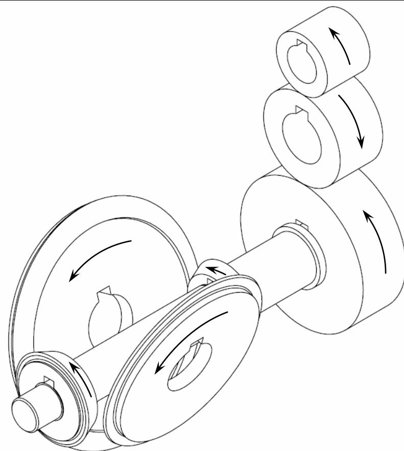
Slika 16. Koncept C – pogonski mehanizam u izometriji
