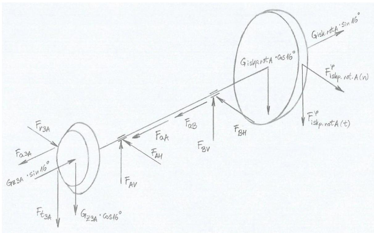
Slika 29. Vratilo A – opterećenje u izometriji
