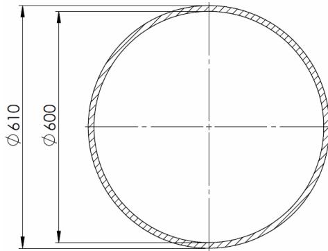
**Slika 52. Proračunski presjek zavara 2 (spoј središnjeg prstena i vanjskog kola)**
