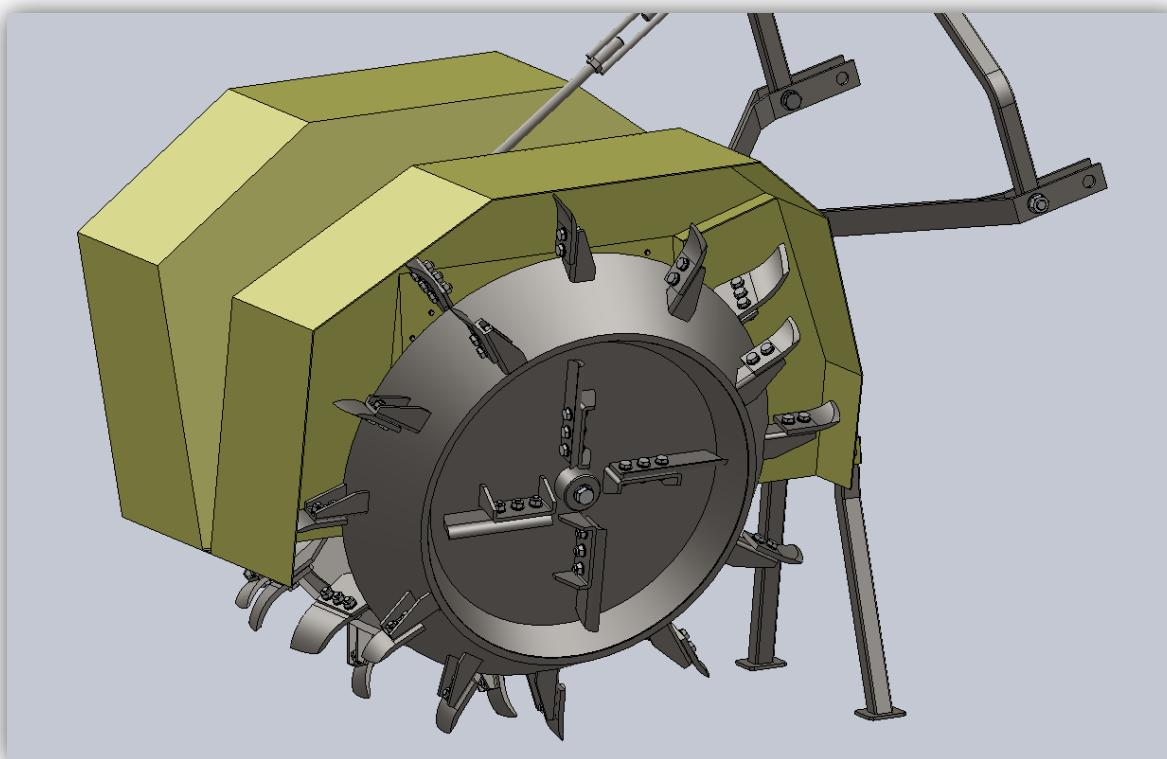
Slika 77. Opasivanje iskapačkog rotora bočnim dijelom zaštitnog lima
