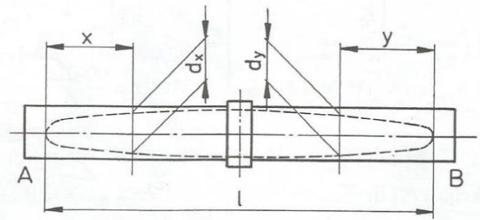
**Slika 28. Vratilo 2 – smjerovi presjeka kod dimenzioniranja**
