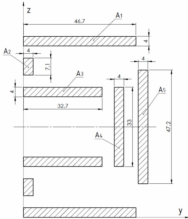
**Slika 49. Proračunski presjek zavara s odsječcima površine**
