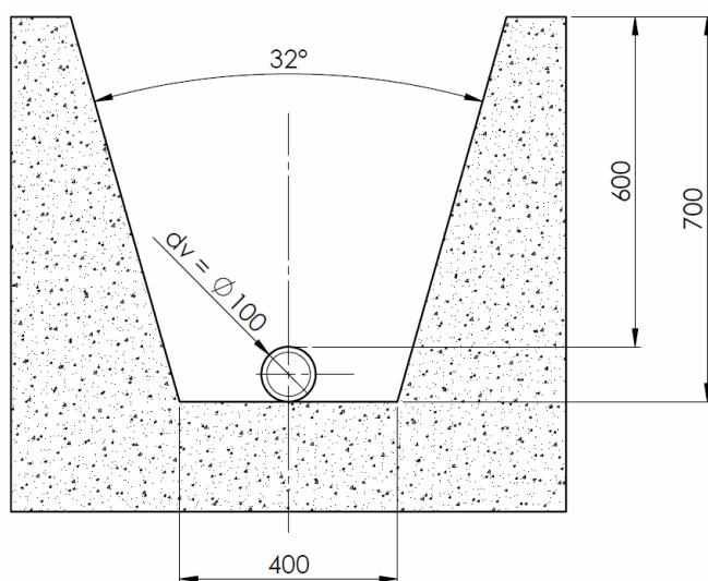
**Slika 20. Orientacijske vrijednosti kanala za dimenzioniranje iskapačkih rotora**
