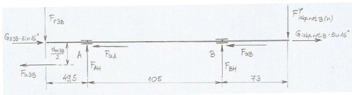
Slika 36. Vratilo B – opterećenje u horizontalnoj ravnini
