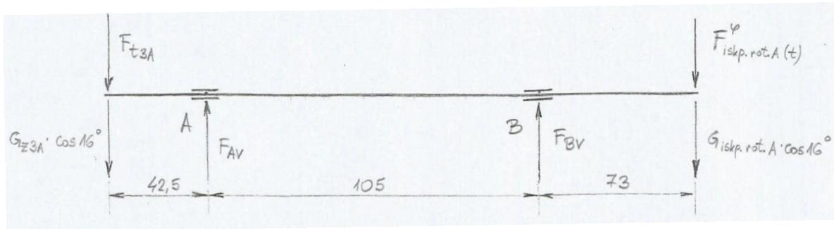
Slika 32. Vratilo A – opterećenje u vertikalnoj ravnini
