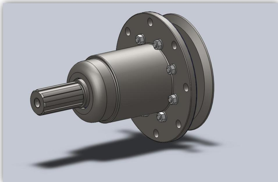
Slika 63. Smještaj bočnog vratila u cilindričnom bočnom kućištu (II)
