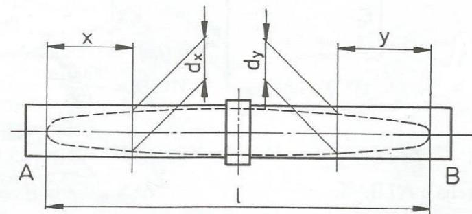
Slika 33. Vratilo A – smjerovi presjeka kod dimenzioniranja
