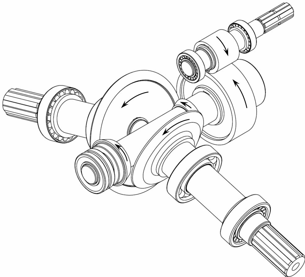
Slika 12. Koncept B – pogonski mehanizam u izometriji
