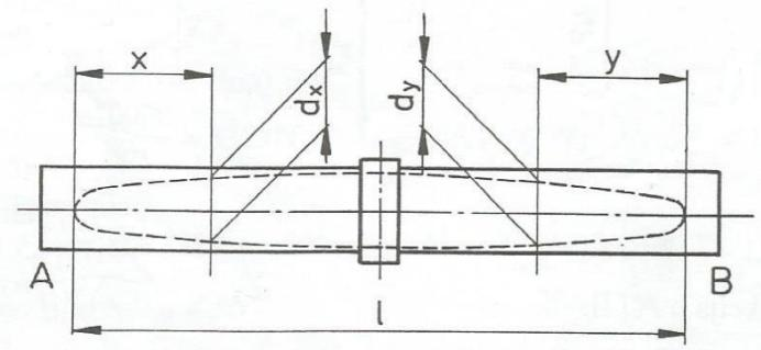
**Slika 38. Vratilo B – smjerovi presjeka kod dimenzioniranja**
