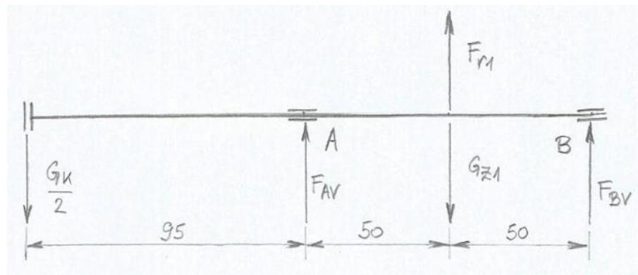
Slika 23. Vratilo 1 – opterećenje u vertikalnoj ravnini
