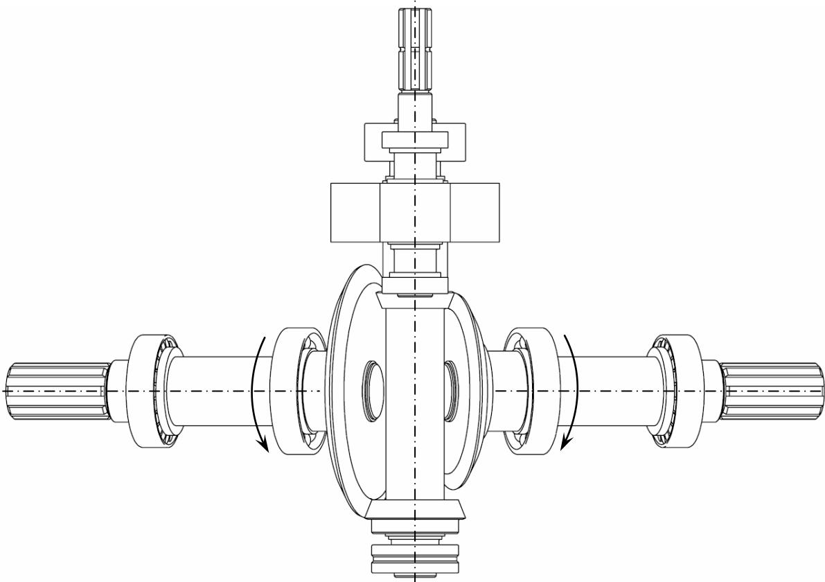
**Slika 14. Koncept B – pogonski mehanizam iz tlocrtnog pogleda**
