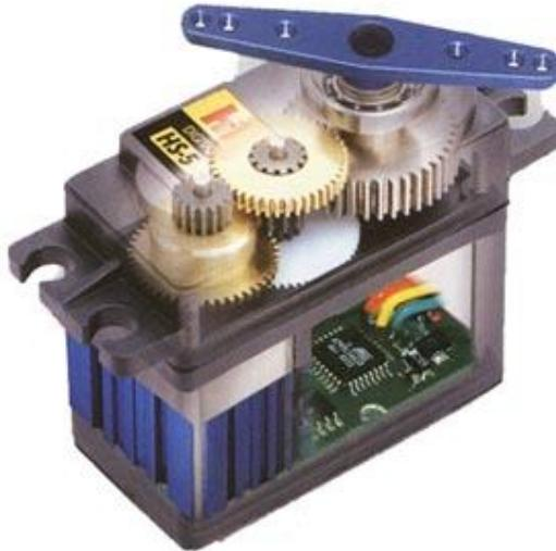
Slika 41. Unutrašnjost servomotora [41]
