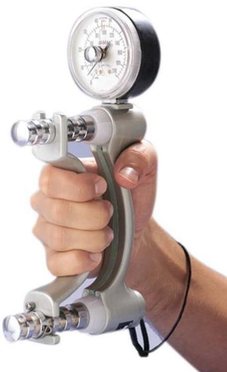
**Slika 19. Mjerenje snage stiska hidrauličnim dinamometrom [18]**
