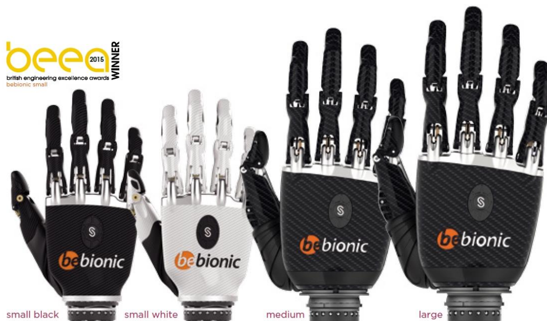
Slika 23. Bionička šaka bebionic [22]
