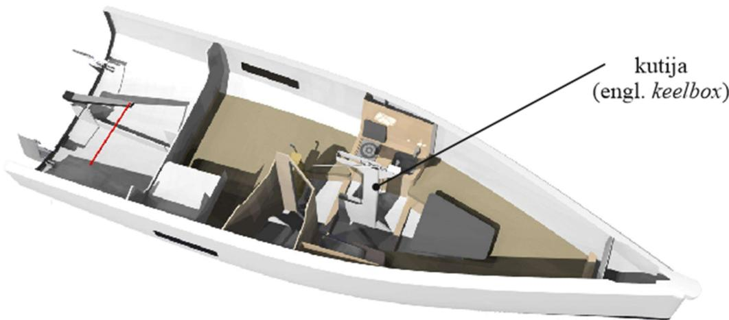
**Slika 3. Presjek jedrilice s kutijom za uvlačivu kobilicu**
