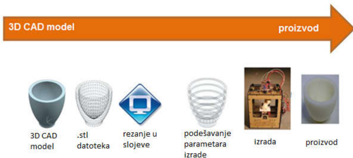
Slika 2.1. Postupak izrade proizvoda [3]
