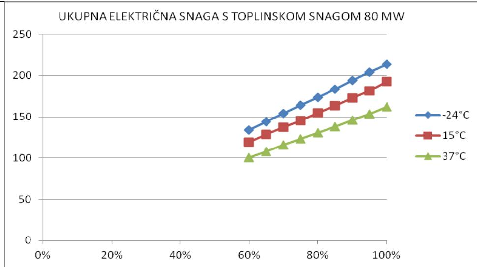
**Slika 60. Uкупна električna snaga s toplinskom snagom 80 MW****Tablica 29. Električna korisnost postrojenja s minimalnom toplinskom snagom**
