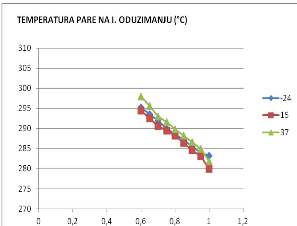
Slika 44. Temperatura pare na I.oduzimanju Tt(2) (°C) (80MW)
