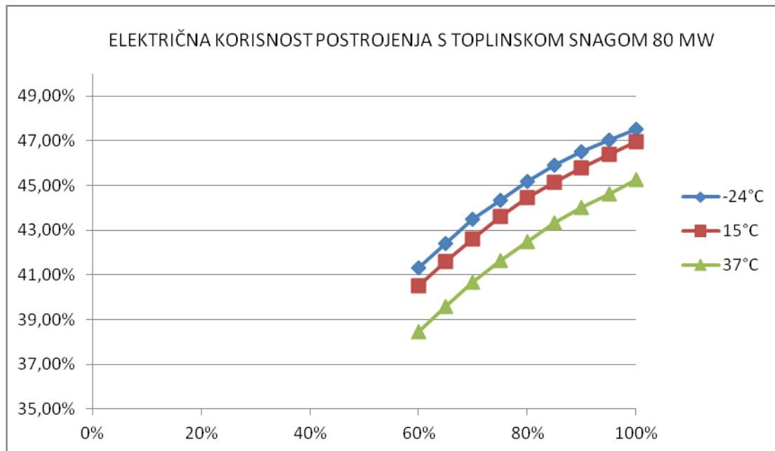
**Slika 62. Električna korisnost postrojenja s toplinskom snagom 80 MW**
