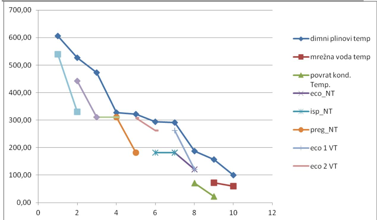
Slika 39. Temperaturni presjek kotla na otpadnu toplinu
