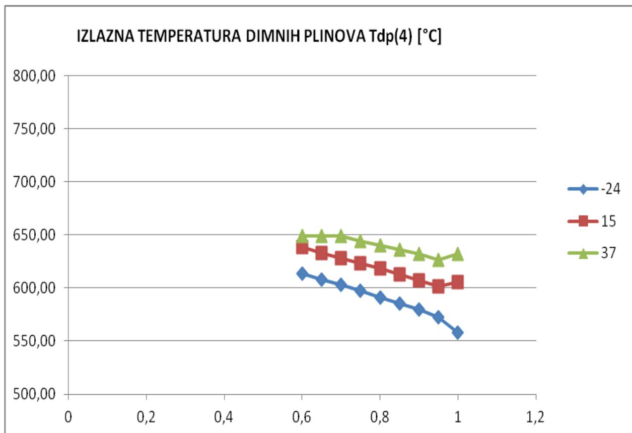
**Slika 25. Izlazna temperatura dimnih plinova iz plinske turbine**
