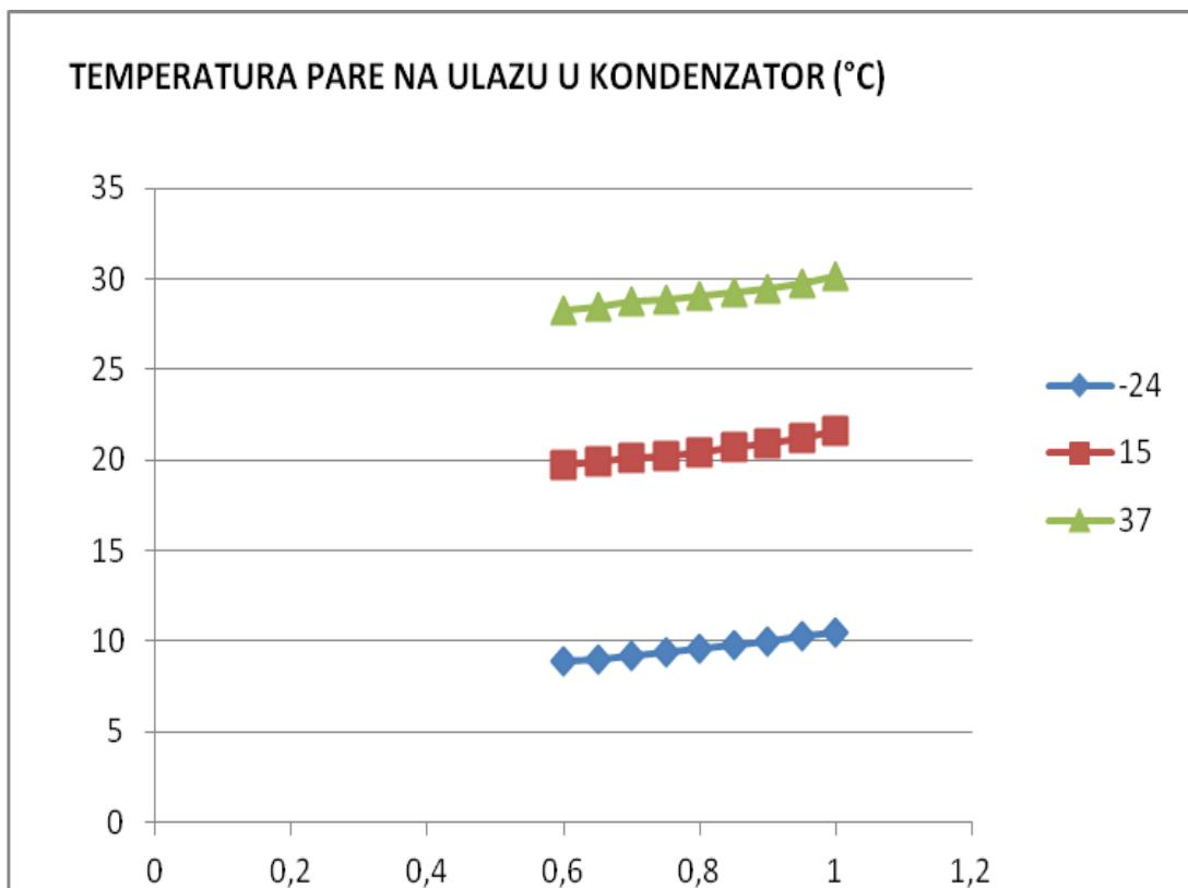
Slika 54. Temperatura pare na ulazu u kondenzator Tt(4) (snaga 80MW) (°C)
