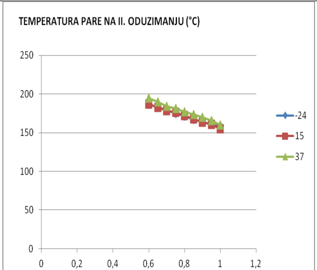
**Slika 49.** Temperatura pare na II.oduzimanju Tt(3) (snaga 80MW) (°C)**Tablica 21.** Temperatura pare na II.oduzimanju Tt(3) (°C)
