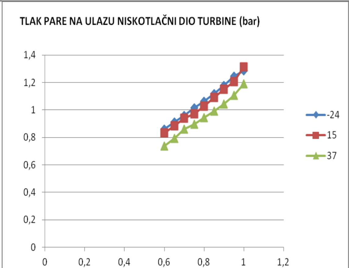
**Slika 52.** Tlak pare na ulazu u niskotlačni dio turbine PT(30) (snaga 80MW) (bar)**Tablica 22.** Tlak pare na ulazu u niskotlačni dio turbine PT(30) (bar)
