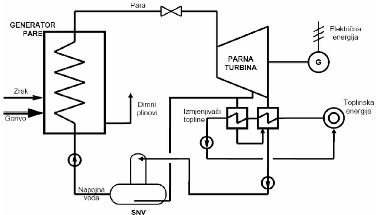
**Slika 12. Shema kogeneracijskog postrojenja s protutlačnom parnom turbinom [8]**
