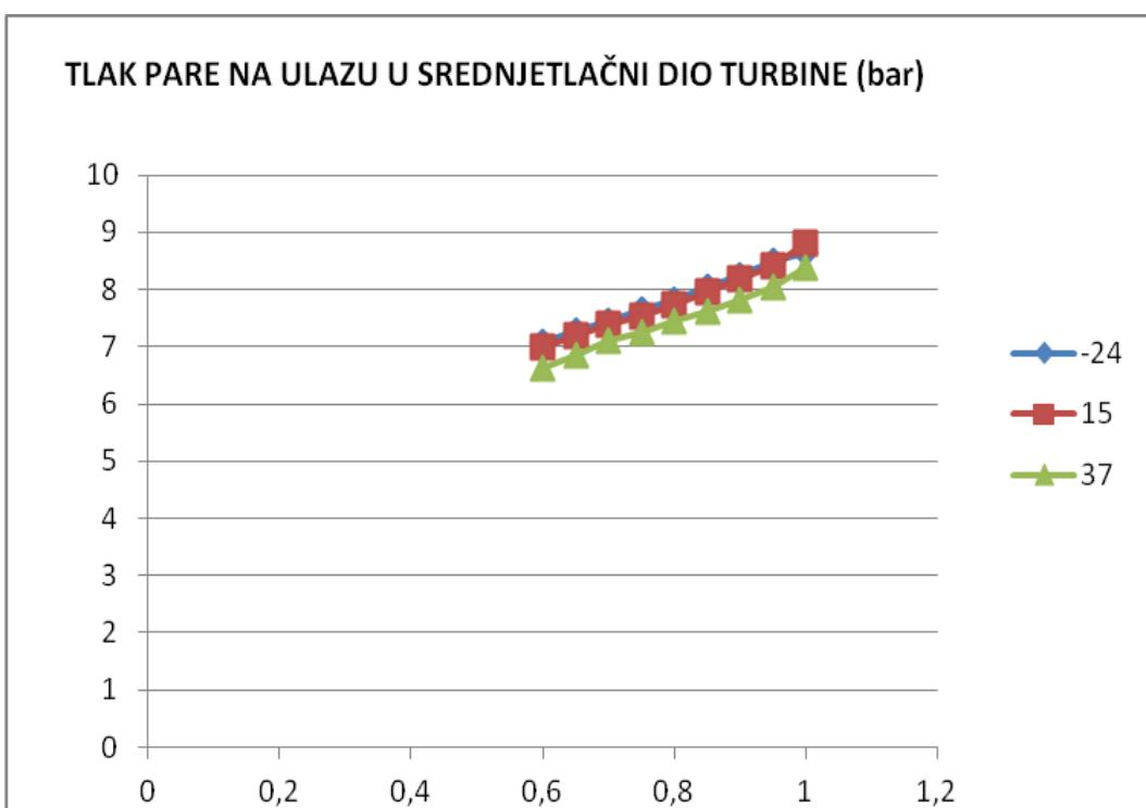
Slika 47. Tlak pare na ulazu u srednjotlačni dio turbine PT(20) (snaga 80MW) (bar)
