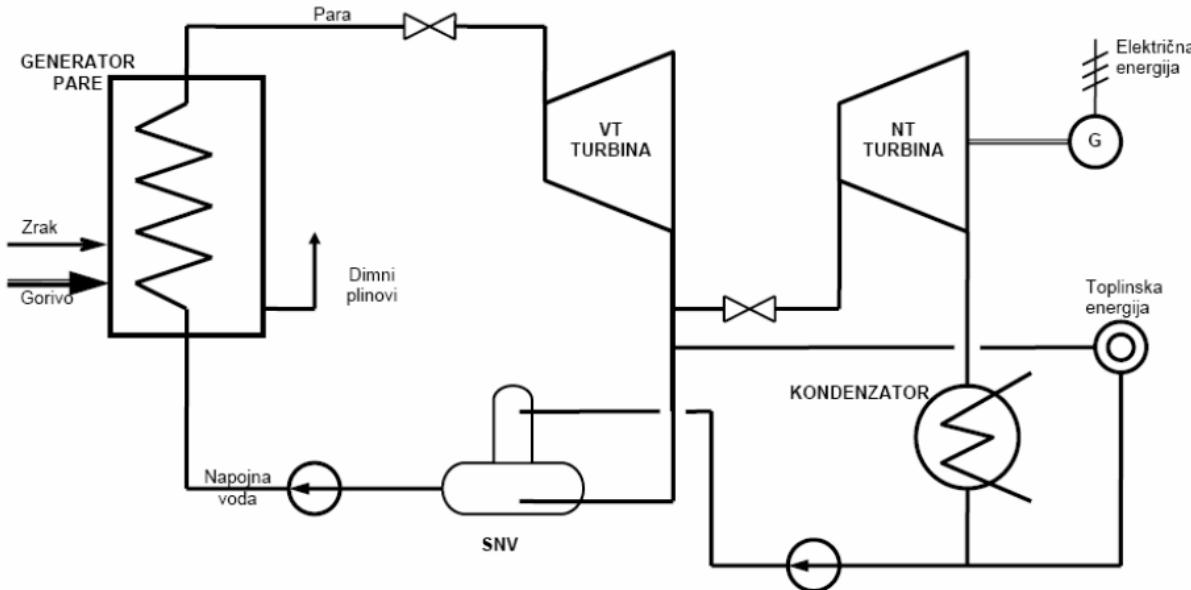
**Slika 13. Shema kogeneracijskog postrojena s kondenzacijskom turbinom s reguliranim oduzimanjem pare [8]**
