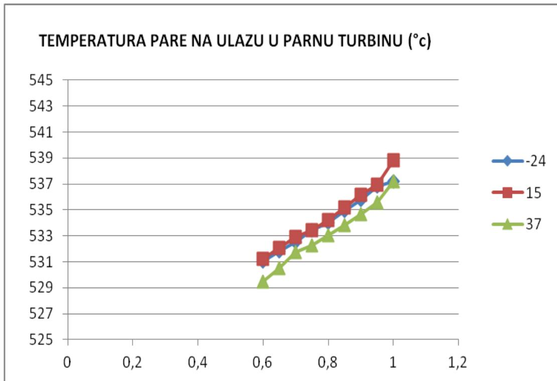
Slika 41. Temperatura pare na ulazu u parnu turbinu  $T_t(1)$  ( $^{\circ}$ C)
