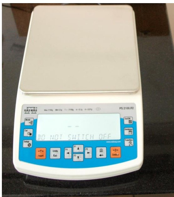
Slika 10. Vaga proizvođača RADWAG tipa PS 2100. R2
