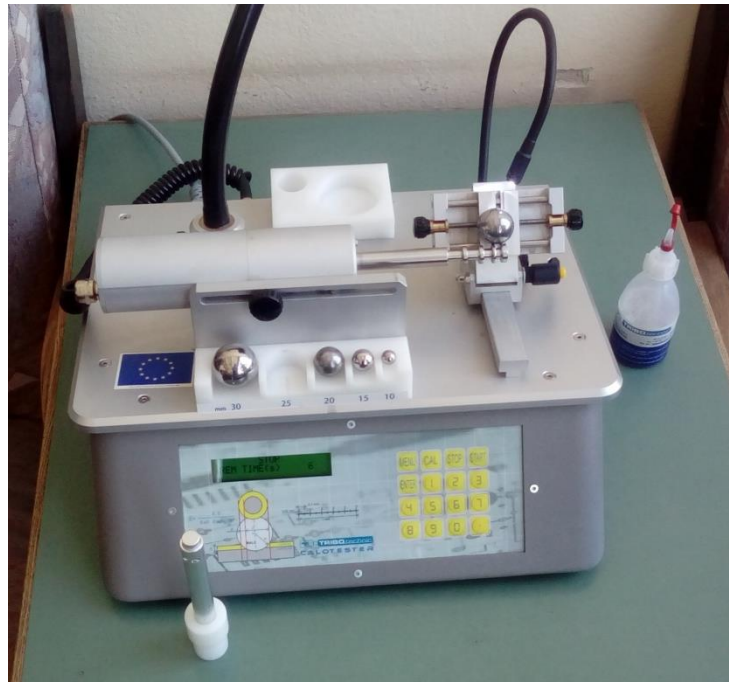
Slika 41. Uređaj za mjerenje debljine prevlake (kalotest)
