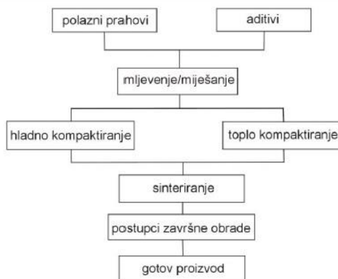
Slika 5. Hodogram tehnoloških operacija konvencionalnog postupka metalurgije praha[6]
