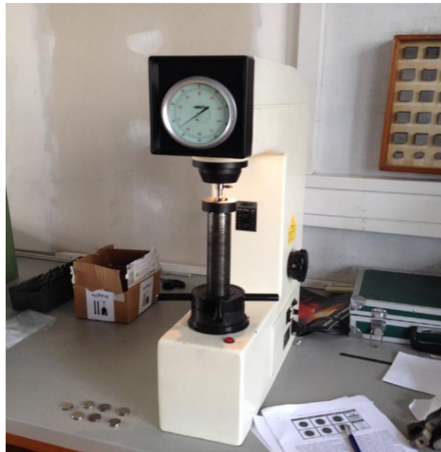
Slika 49. Uređaj za mjerenje Rockwellove tvrdoće
