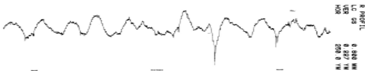
Slika 58. Profil hrapavosti osnovnog materijala, uzorak 1
