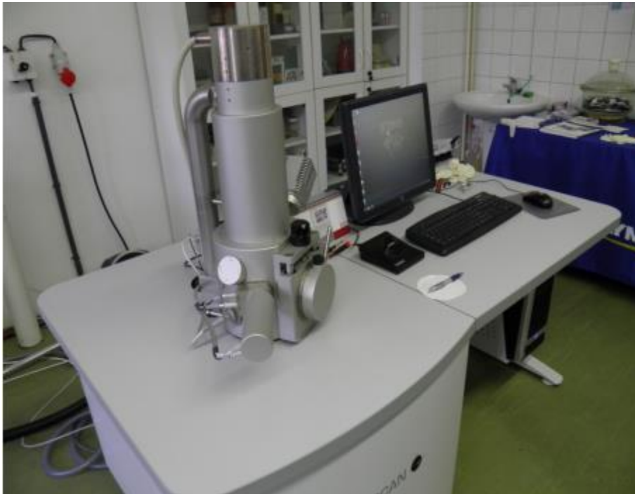
Slika 33. Skenirajući elektronski mikroskop
