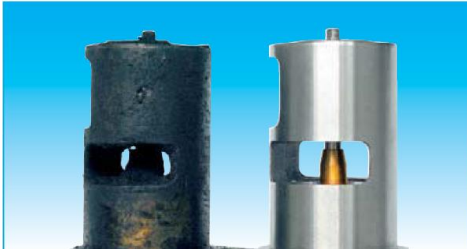
Slika 22. Usporedba EGR ventila sa obilnim naslagama i novog EGR ventila [6]
