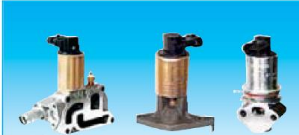
Slika 21. Konstrukcije EGR ventila kod benzinskih motora [6]
