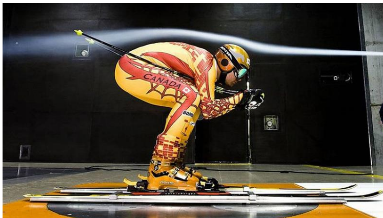
Slika 5. Ispitivanje aerodinamičnosti skijaša [16]
