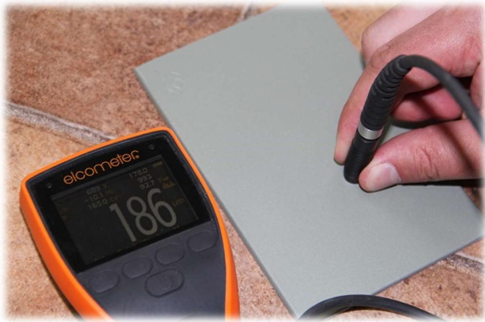
Slika 37. Uređaj Elcometer 456 za mjerjenje debljine prevlake [10]
