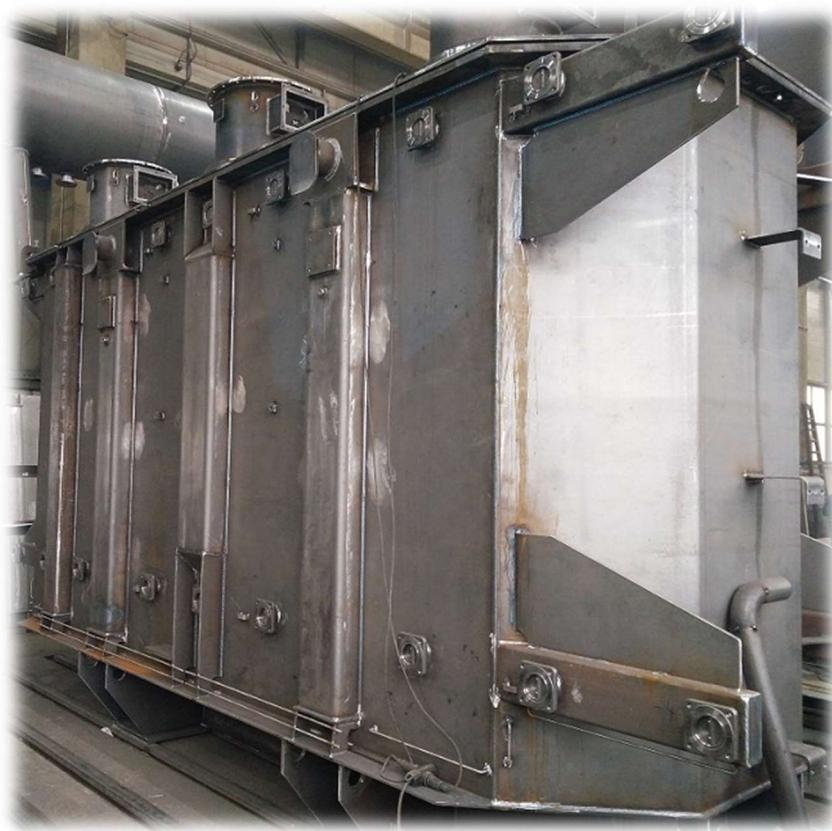
**Slika 23. Stanje površine kućišta nakon ispitivanja na nepropusnost sapunicom,
