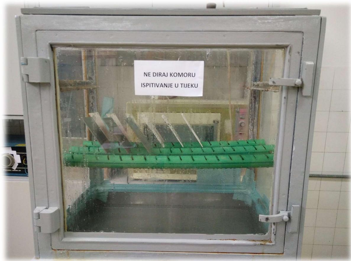
Slika 47. Vlažna komora i uzorci u njoj [10]
