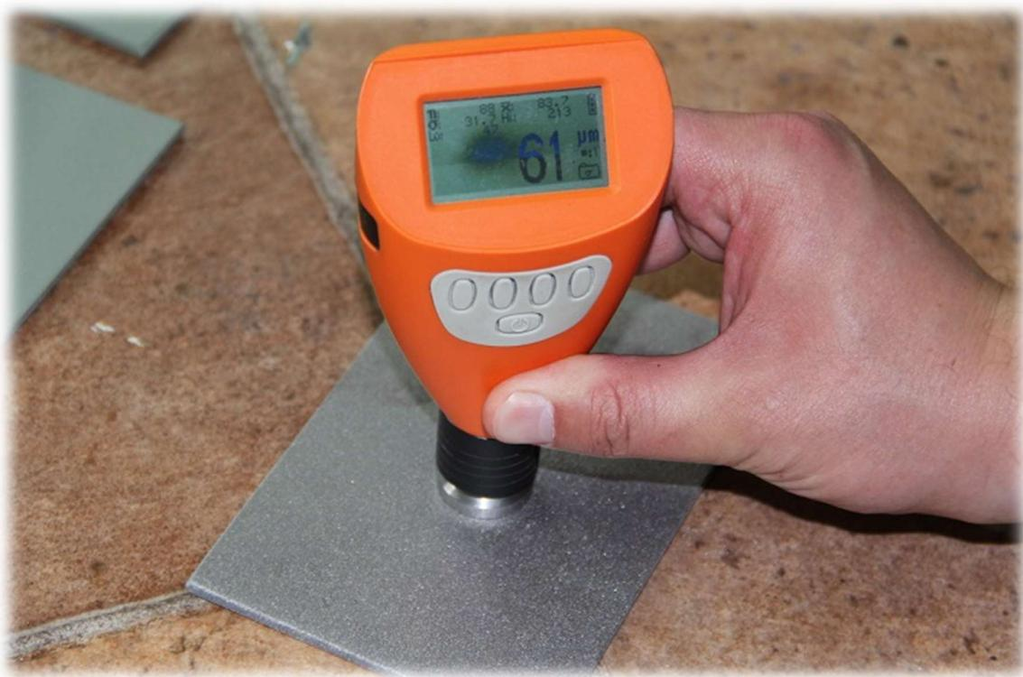
Slika 36. Uzorak 18 i uređaj Elcometer 224 za mjerjenje hrapavosti površine [10]
