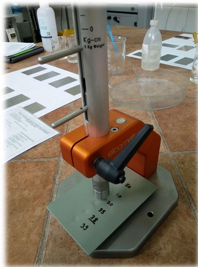
Slika 41. Uredaj Elcometer 1615 za mjerjenje otpornosti na udar [10]
