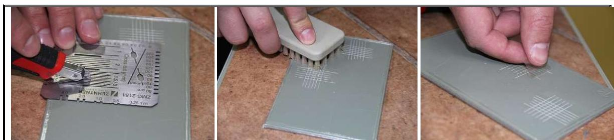
Slika 50. Postupak ispitivanja prionjivosti premaza [10]
