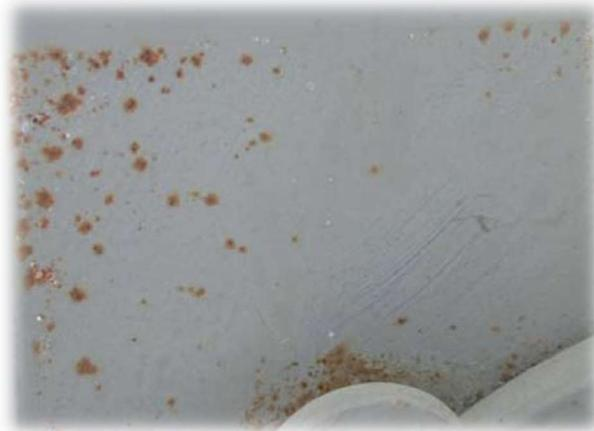
**Slika 32. Korozija u procjepu između temelja i dna transformatora [9]**
