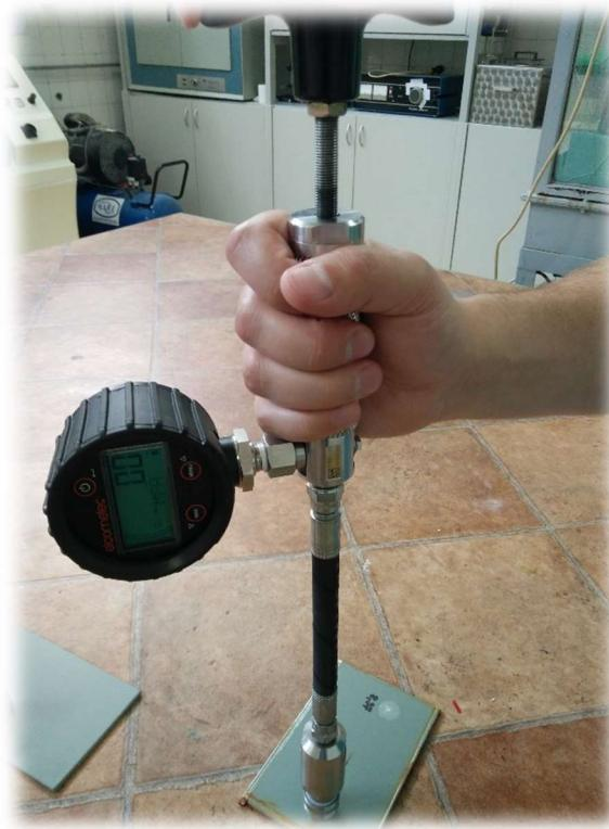
**Slika 51.** Uređaj Elcometer 108 za ispitivanje vlačne čvrstoće premaza [10]
