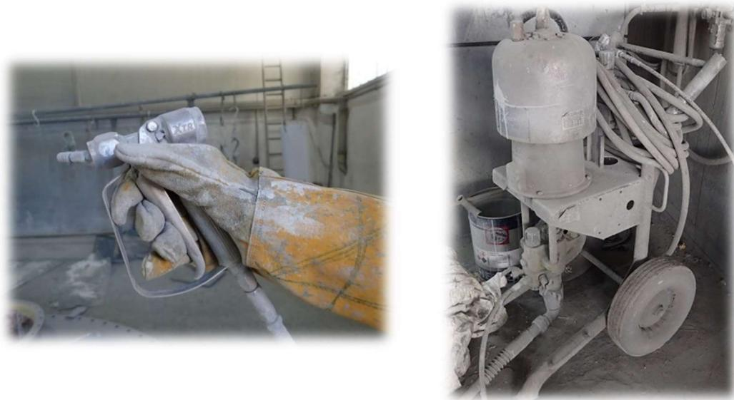
Slika 27. Nanošenje premaza bezračnim postupkom [1]
