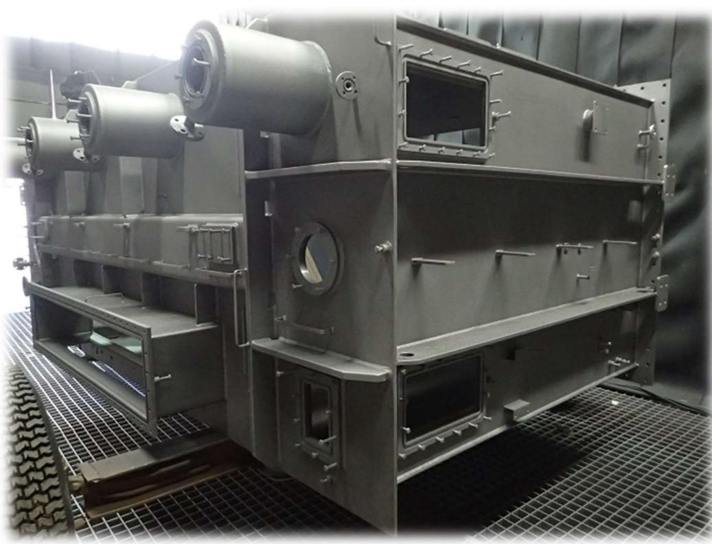
Slika 24. Stanje površine kućišta nakon sačmarena, Komet d.o.o. [1]
