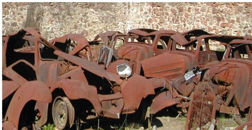
Slika 2. Primjer kemijskog oštećivanja atmosferskom korozijom [5]
