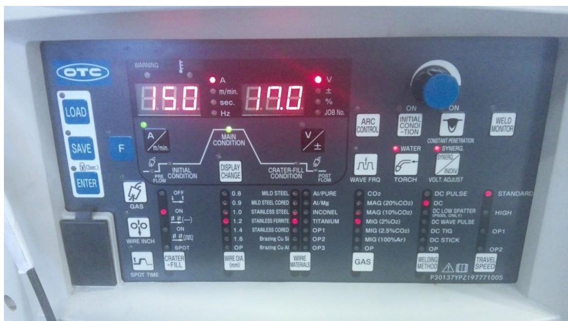
Slika 30. Parametri zavarivanja pri zavarivanju feritnog nehrđajućeg čelika
