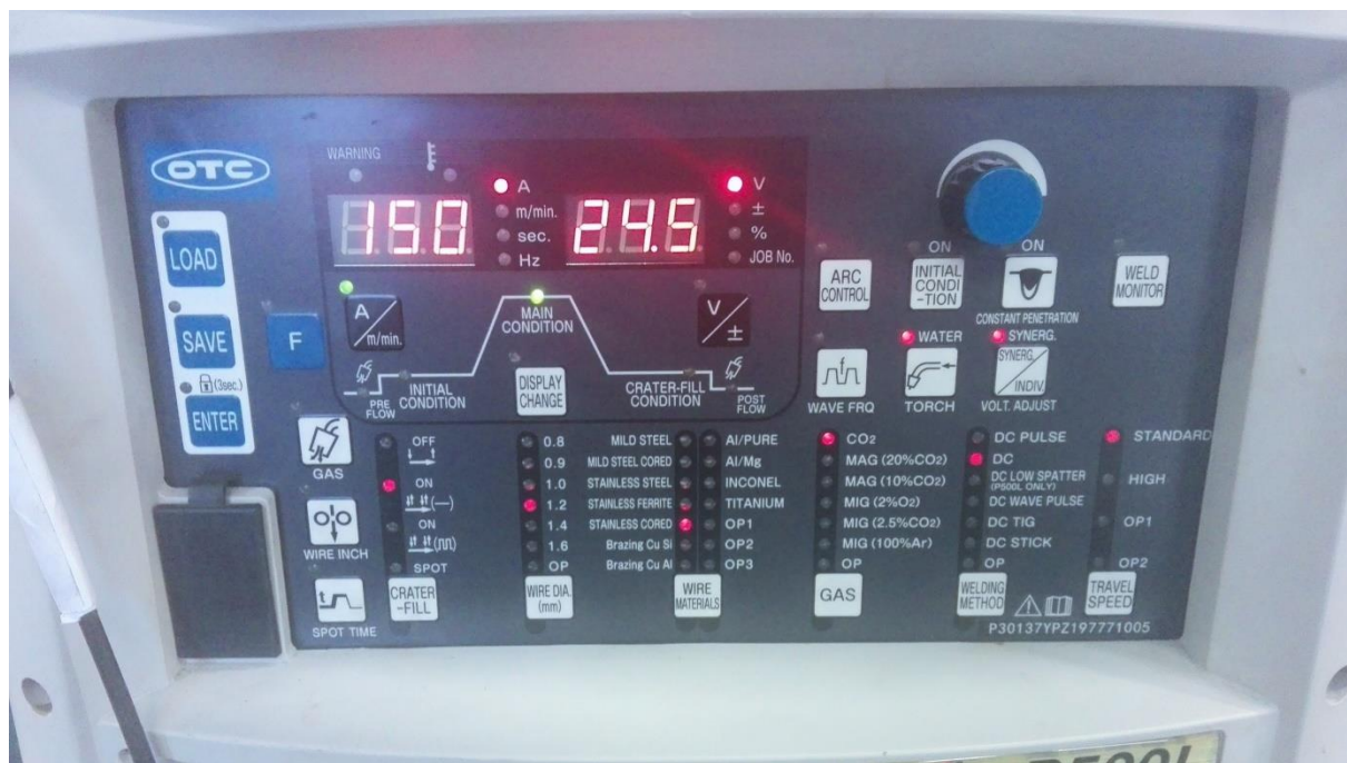
Slika 31. Parametri zavarivanja pri zavarivanju nehrđajućeg čelika praškom punjenom žicom
