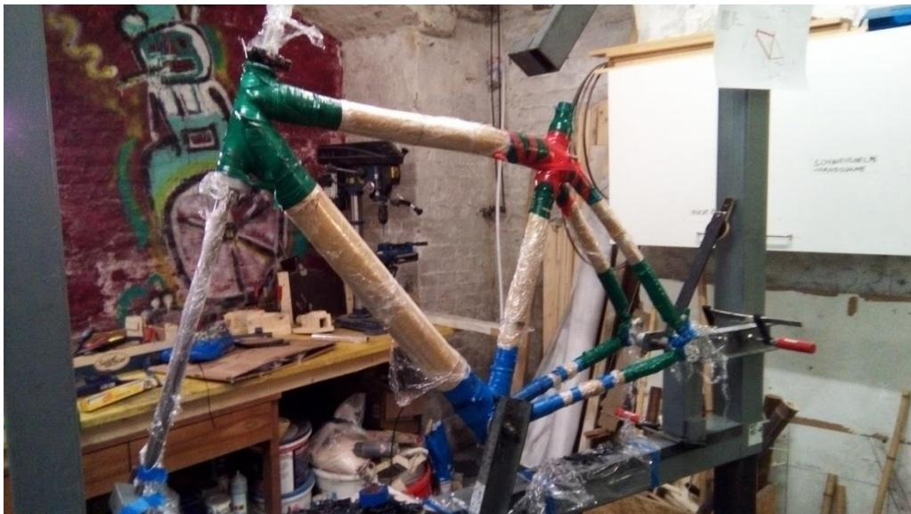
Slika 64. Nanošenje trake na kompozit s ugljičnim vlaknima
