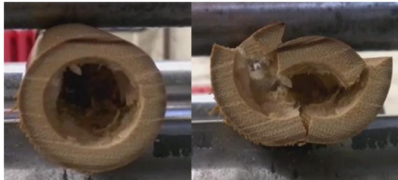
Slika 39. Lom uslijed savijanja uzorak 25-3
