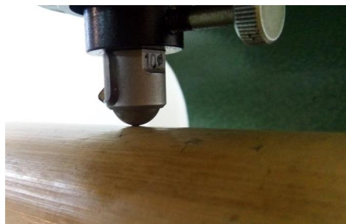
Slika 43. Ispitivanje tvrdoće bambusa
