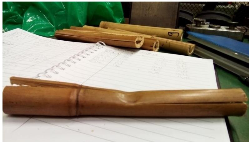
Slika 59. Uzorak opterećen na savijanje
