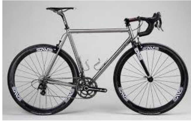
Slika 10. Okvir od titanove legure [23]
