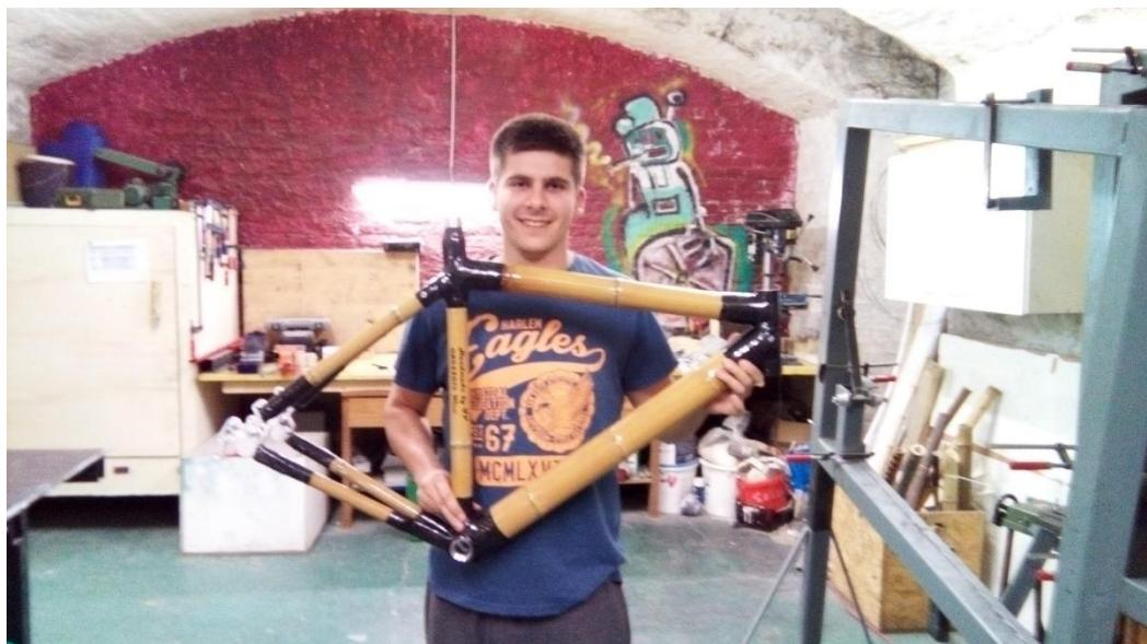
Slika 67. Izrađeni okvir od bambusa i ugljičnih vlakana
