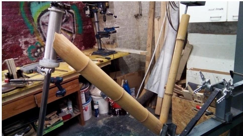
Slika 62. Postavljanje cijevi na napravu
