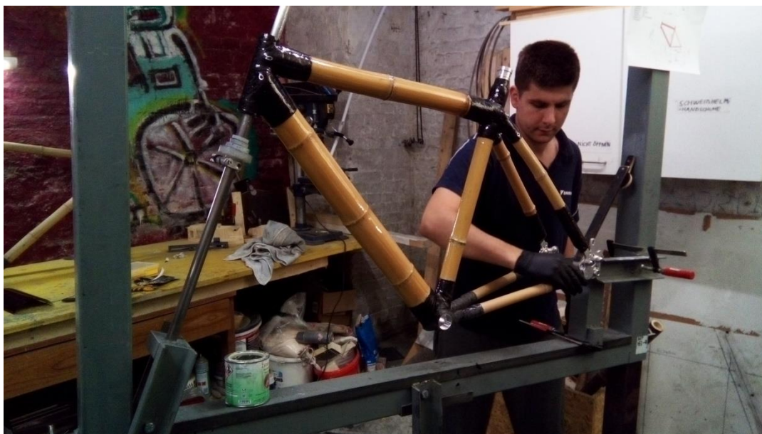
Slika 66. Nanošenje zaštitnog sloja na okvir
