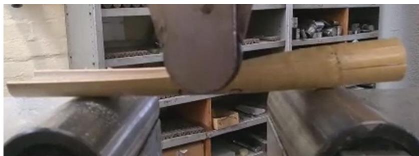
Slika 40. Lom uslijed savijanja uzorak 13-2
