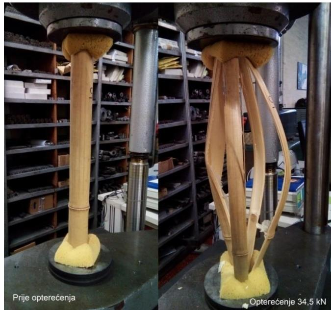
Slika 42. Izvijanje uzorka 5
