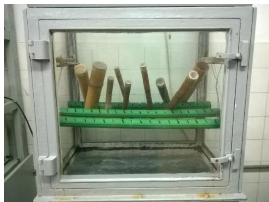
Slika 52. Uzorci u vlažnoj komori
