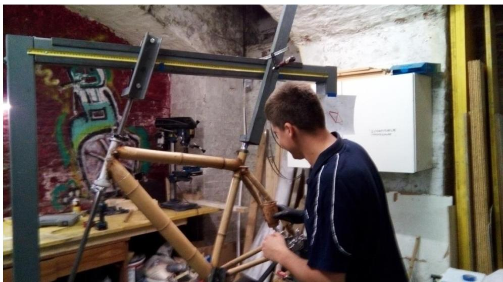
Slika 63. Lijepljenje spojeva
