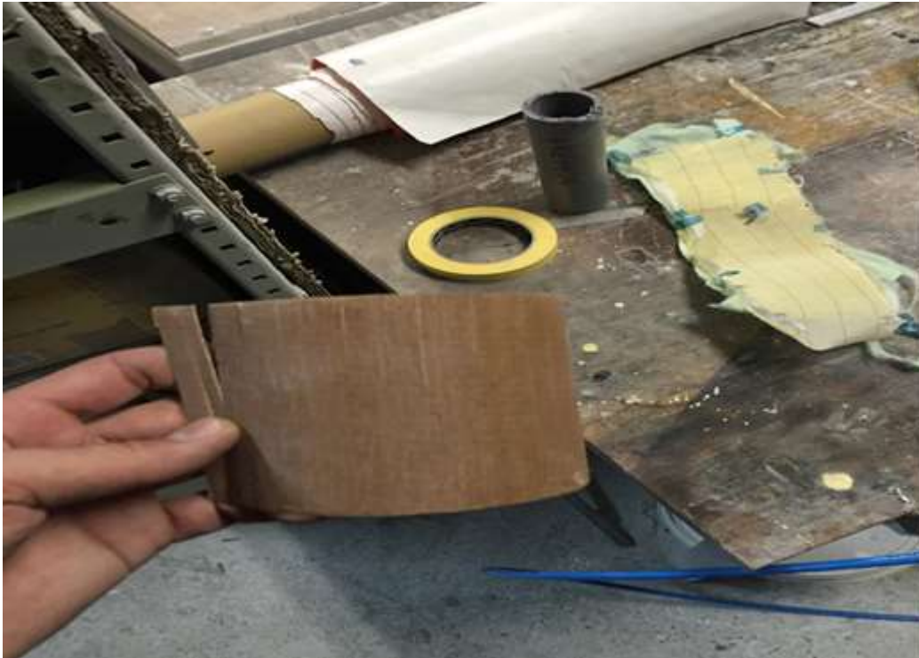
Slika 45. Lom kompozitnog uzorka
