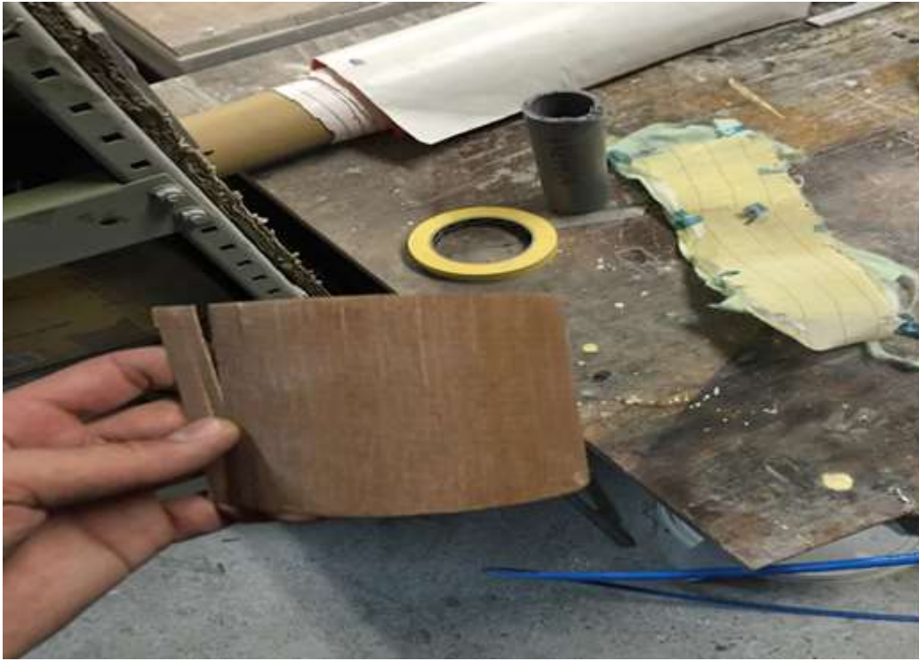
Slika 45. Lom kompozitnog uzorka
