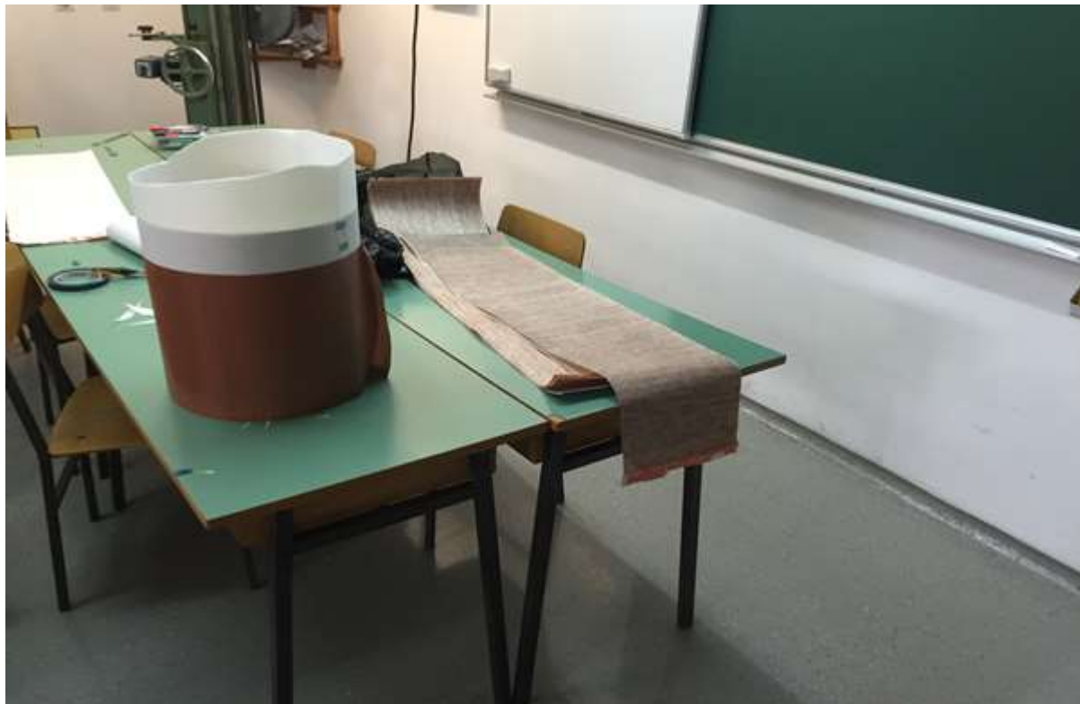
Slika 48. Postupak slaganja slojeva oko kalupa
