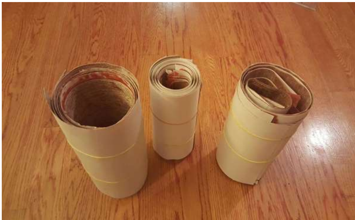
Slika 47. Izrezani slojevi od lanenog preprega
