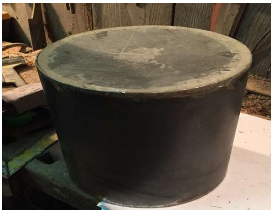
Slika 43. Kalup od čeličnog lima
