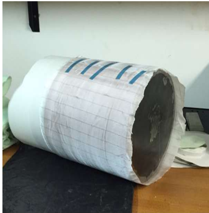
Slika 49. Omotana tkanina za odjeljivanje (eng. peel ply )
