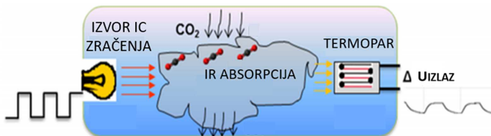
Slika 2.4 Osnovni princip rada NDIR senzora [12.]
