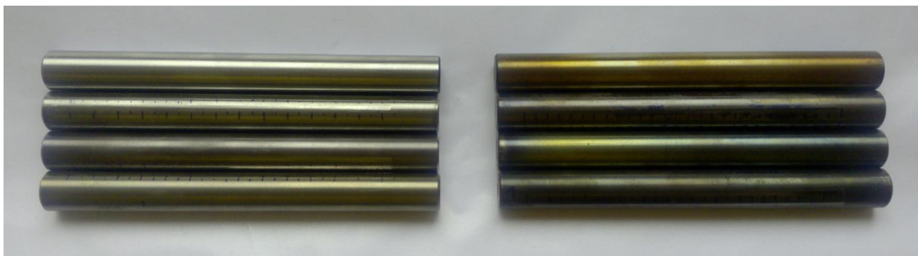
Slika 28. Uzorci za "load scanning" ispitivanje
