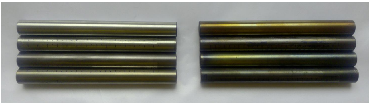
Slika 28. Uzorci za "load scanning" ispitivanje
