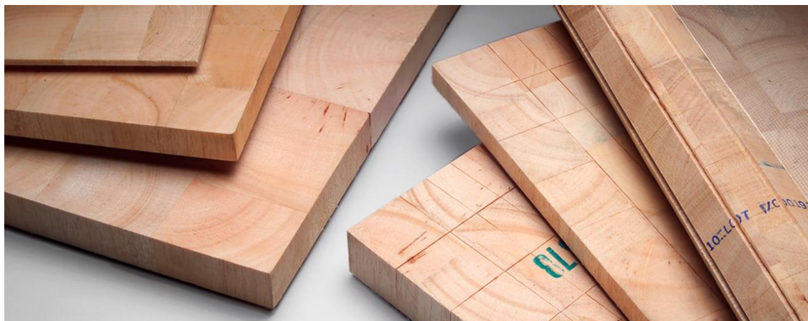
Slika 4.18. Ploče balze pripremljene za sendvič strukture [16]
