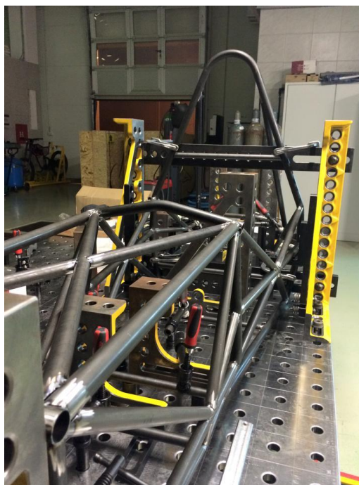
Slika 2.9. Nosiva konstrukcija na zavarivačkom stolu
