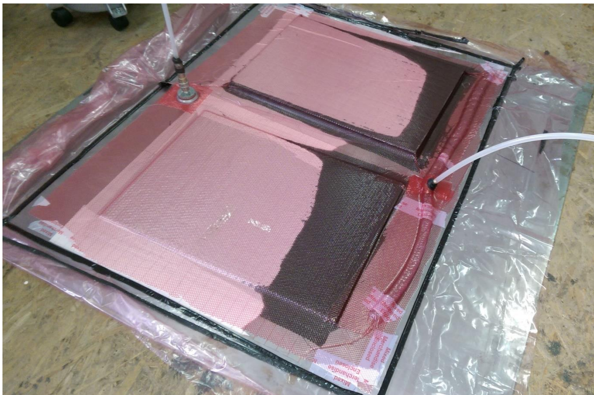
Slika 5.10. Popunjavanje laminata smolom kroz razdoblje od 5 minuta
