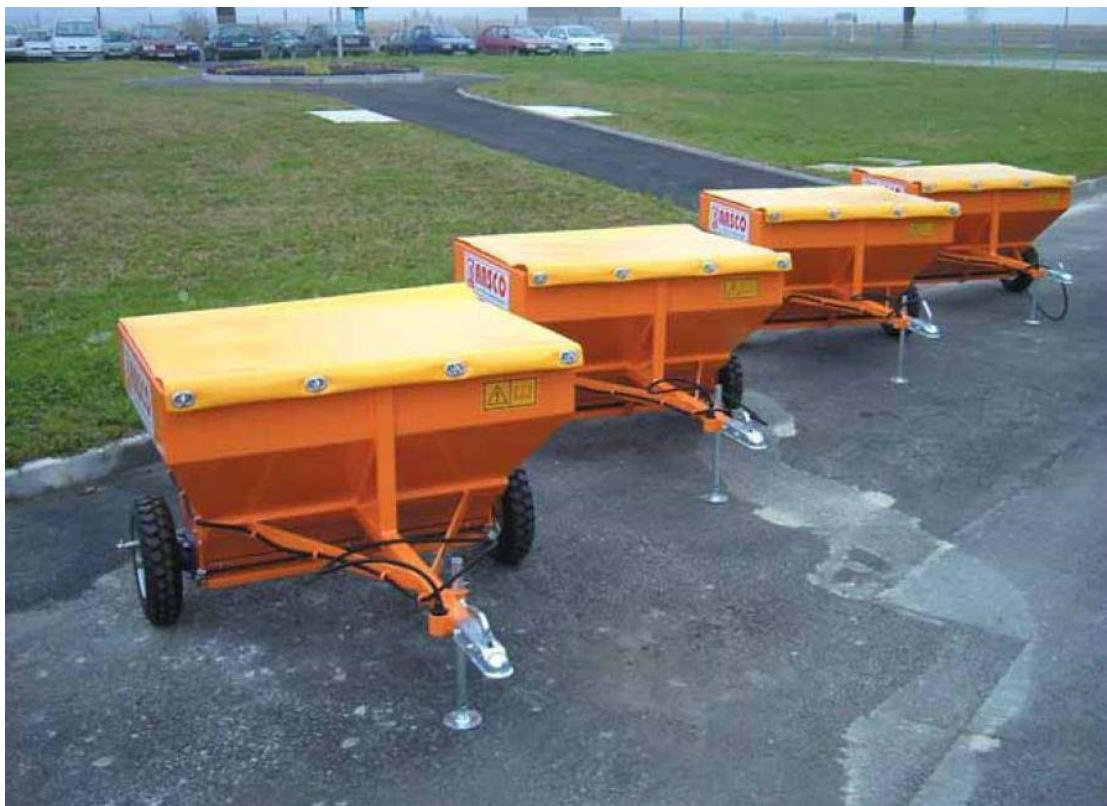
Slika 2.12. Vučni posipač MINI [3]
