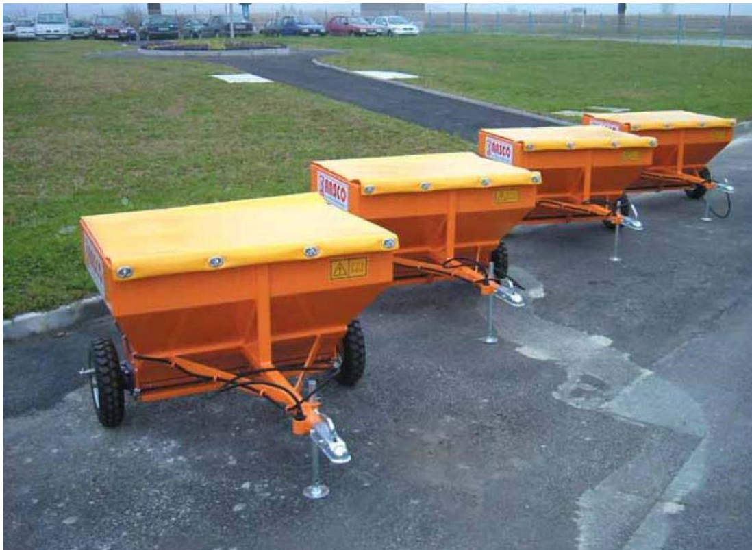
Slika 2.12. Vučni posipač MINI [3]
