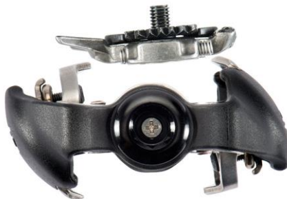
Slika 21. Bočni pogled na SYZR pedalu s blokejem [17]
