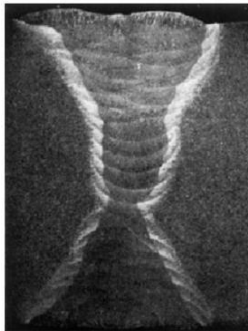
Slika 25. Metalografski uzorak makroizbruska zavarenog spoja u nagriženom stanju [1]
