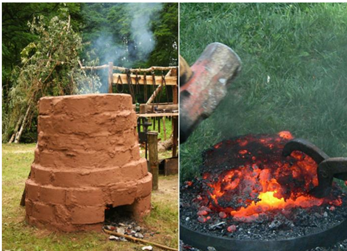
Slika 6. Plitko ognjište (lijevo) i spužvasto željezo izvađeno iz donjeg dijela plitkog ognjišta (desno)
