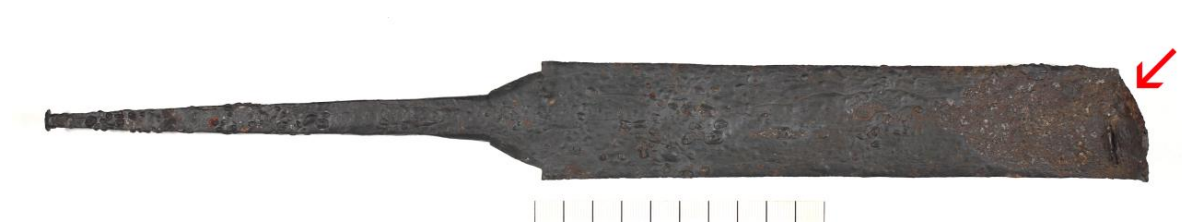
Slika 33. Dio keltskog mača s naznačenim područjem s kojeg je uzet uzorak za analizu
