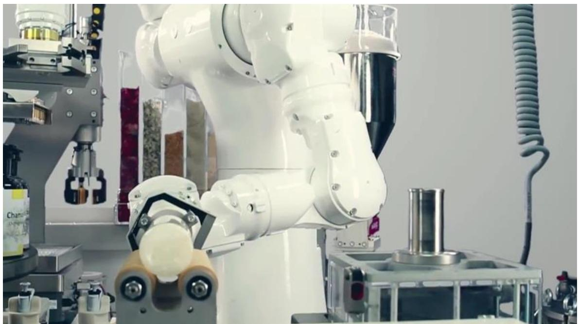
Slika 69. Lijepljenje etikete na ambalažu položenu na rotirajuće valjke [14]
