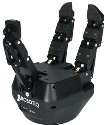
Slika 80. Prilagodljiva robotska hvataljka s tri osjetljiva prsta [17]
