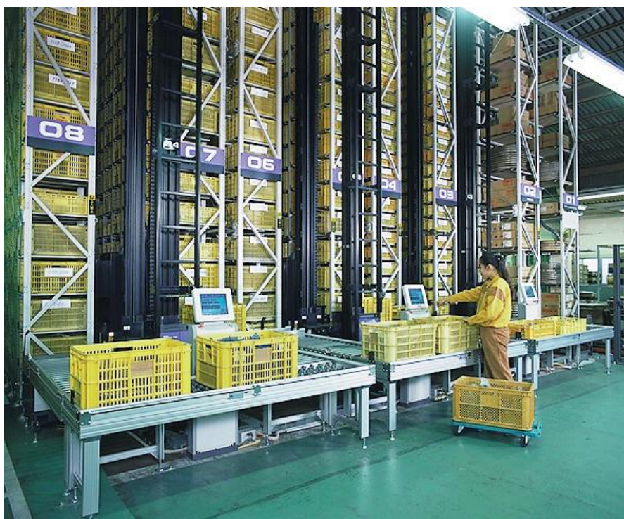
Slika 15. Skladišni sustav s 3 mini-load dizalice
