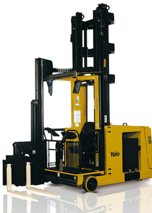
Slika 33. Viličar s pomičnom kupolom Yale MTC-13
