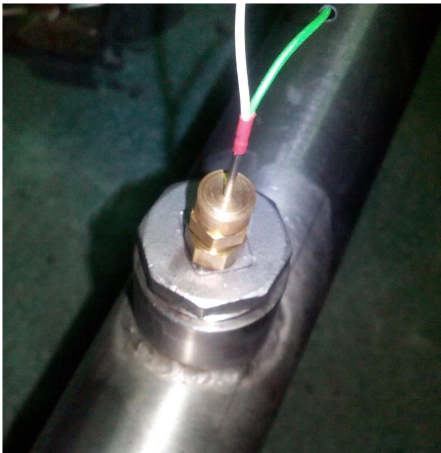
Slika 4.5. Prikaz spojenog termopara na cijevi.
