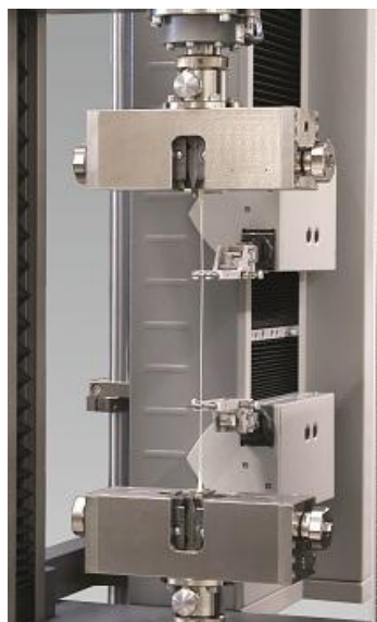
Slika 10. Mjerenje „sensor arm“ ekstenzometrom [48]
