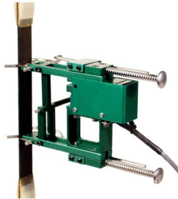
Slika 9. Mjerenje „clip on“ ekstenzometrom [46]
