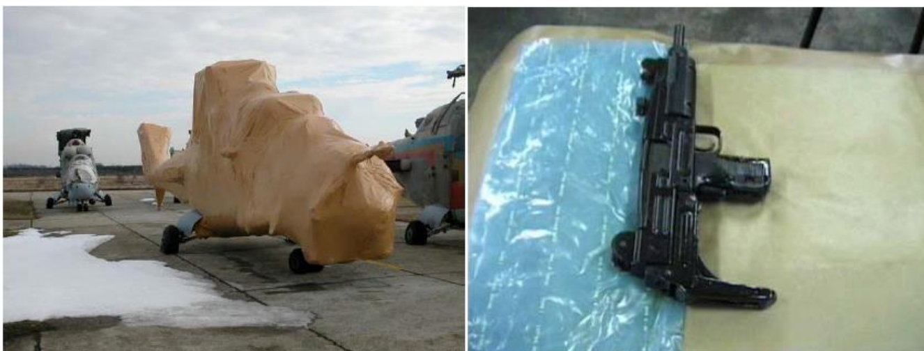
Slika 18. Primjena inhibitora korozije za zaštitu borbenih letjelica (lijevo) i pješačkog naoružanja (desno) [14]
