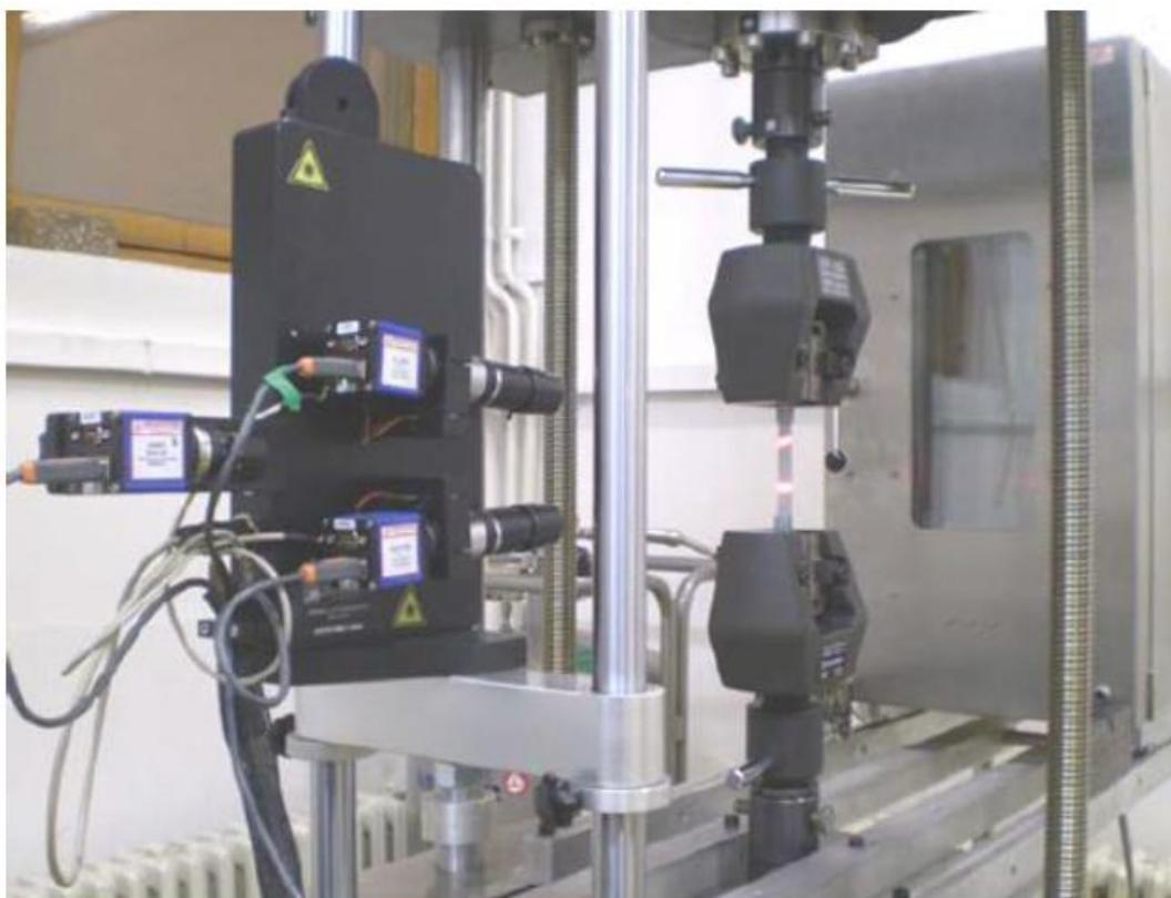
Slika 7. Mjerenje laserskim ekstenzometrom
