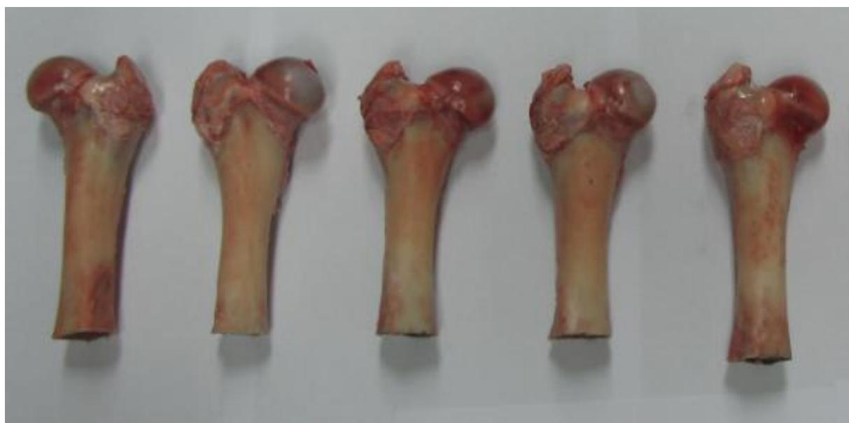
Slika 18. Svinjski femuri nakon odrezivanja distalnog dijela
