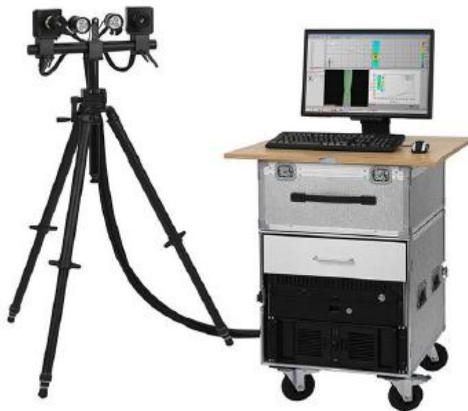
**Slika 12. Optički mjerni sustav Aramis [6]**
