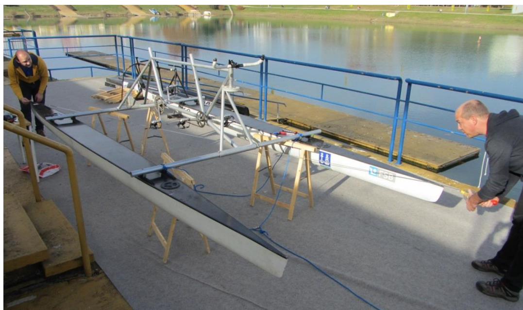
Slika 6. Mjerenje dijagonala trupova
