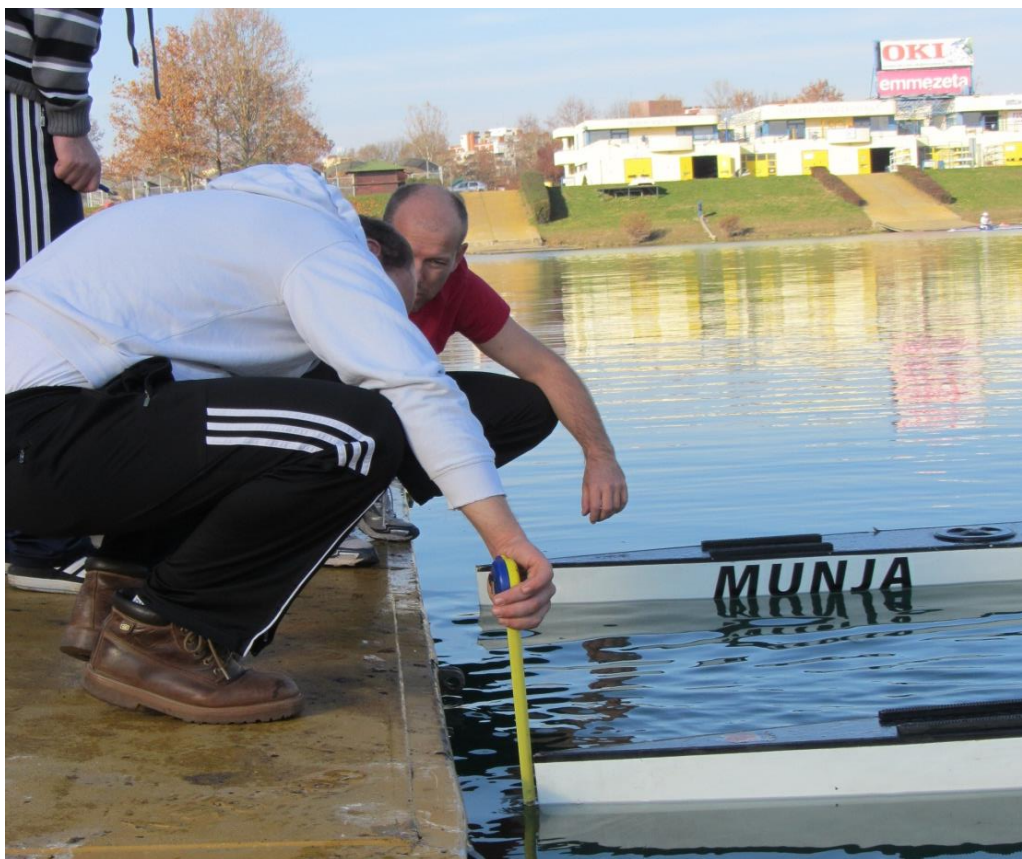
Slika 14. Mjerenje gazova brodocikla
