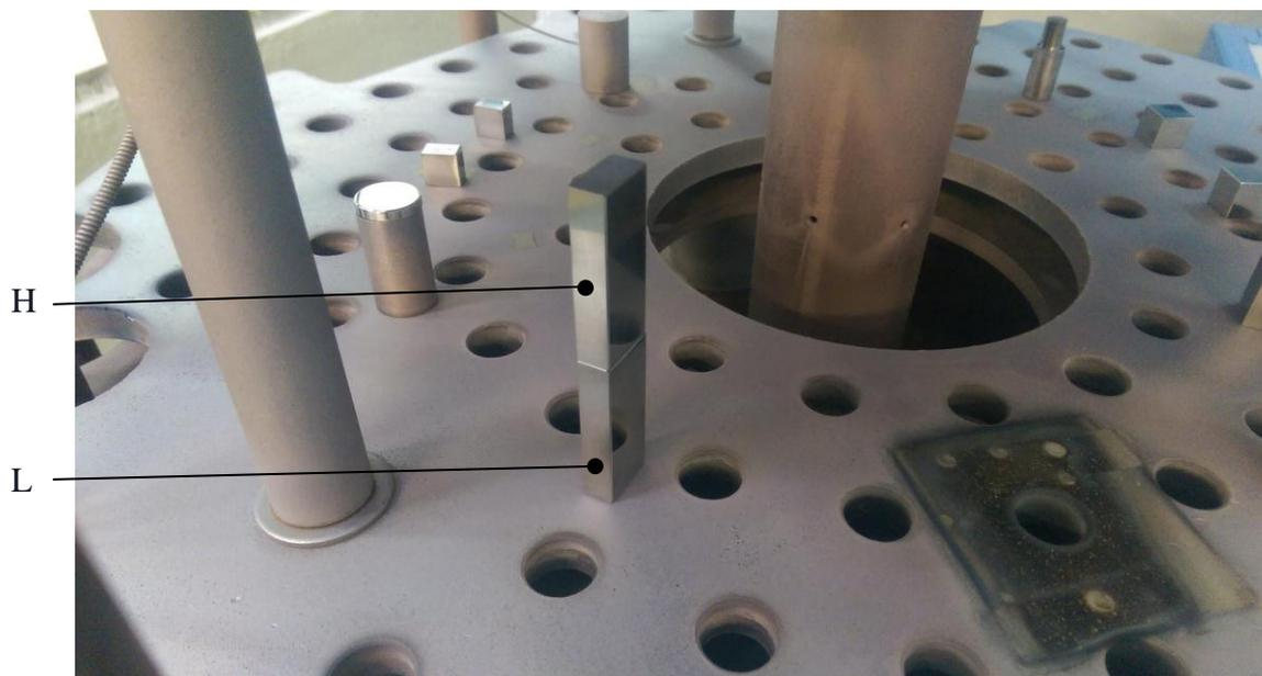
**Slika 3.4 Položaj uzoraka u uređaju za prevlačenje**
