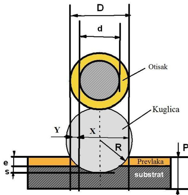
**Slika 3.10 Princip mjerenja debljine prevlake kalotestom [12]**
