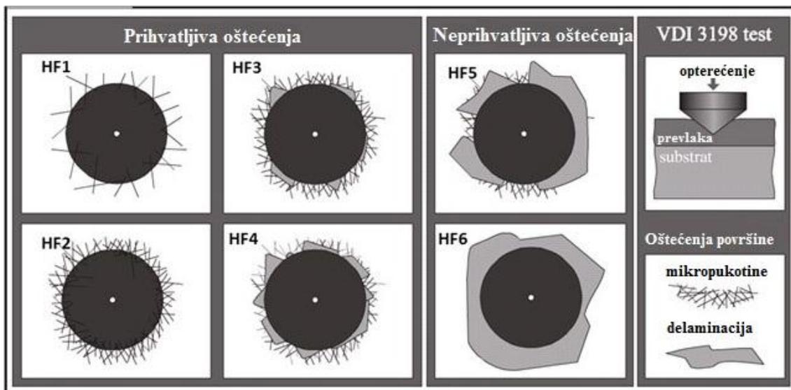
Slika 3.14 Klasifikacija prionjivosti prevlake metodom HRC [14]
