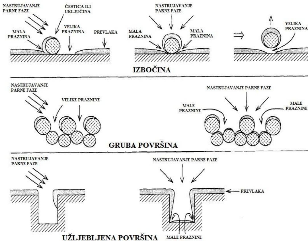
**Slika 2.5 Utjecaj površinskih nepravilnosti na depoziciju prevlake [6]**
