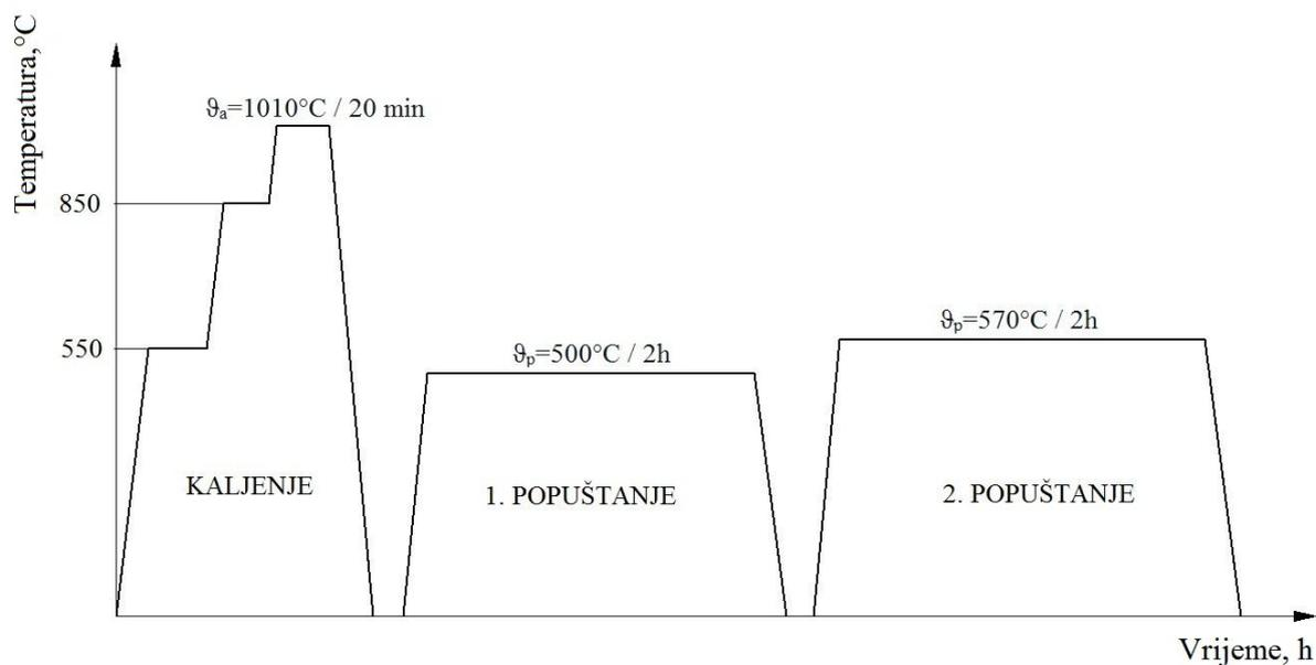
**Slika 3.2** Dijagram postupka osnovne toplinske obrade čelika X37CrMoV5-1
