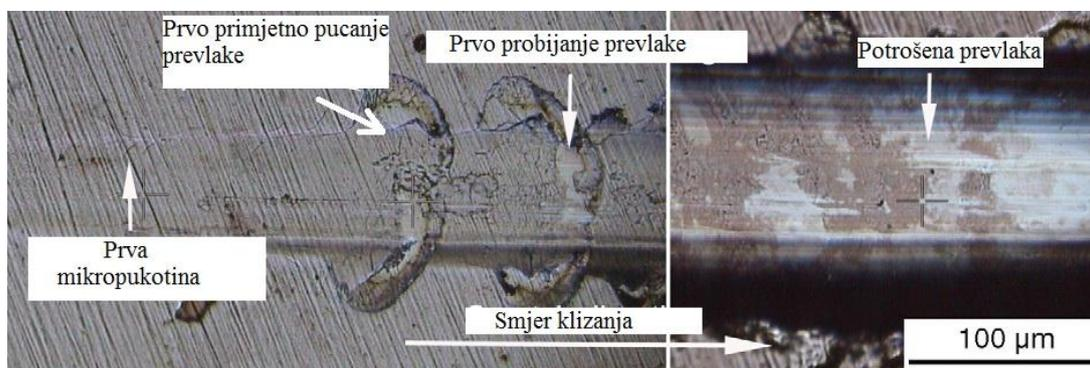
Slika 2.10 Scratch-test na TiBN prevlaci bez prethodnog nitriranja [7]
