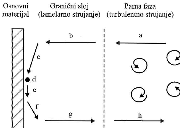
**Slika 2.4 Shematski prikaz pojedinačnih faza CVD procesa [1]**
