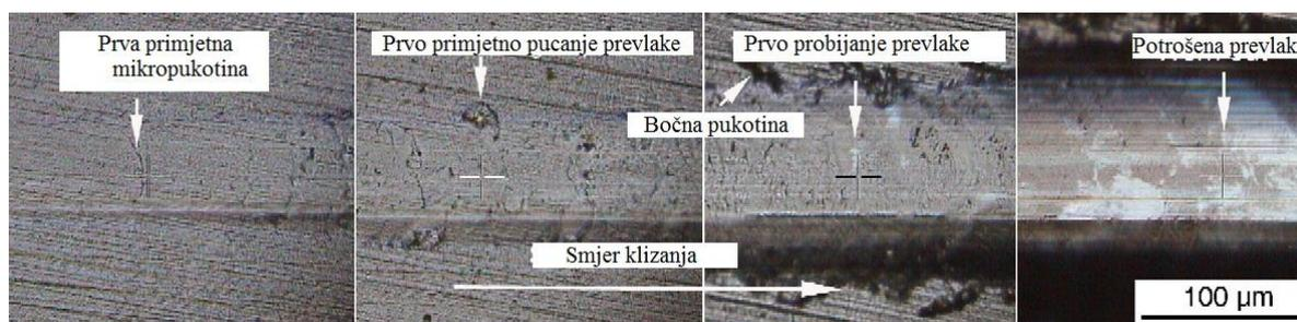
Slika 2.11 Scratch-test na TiBN prevlaci s prethodnim nitriranjem [7]
