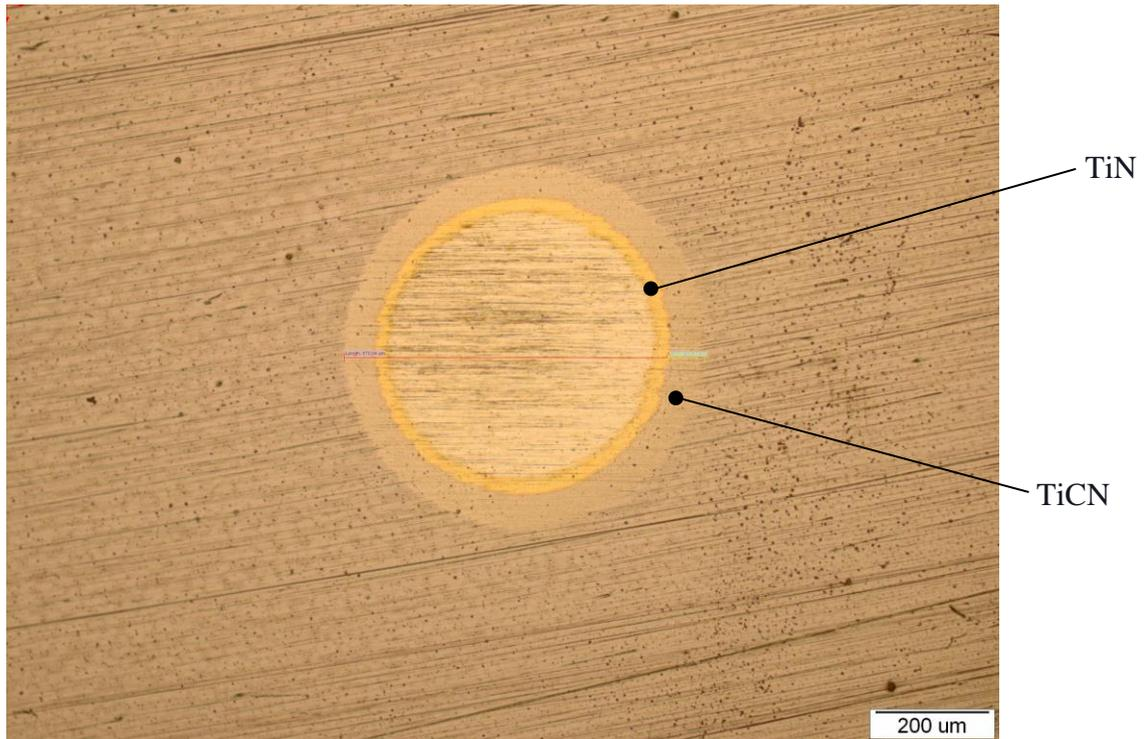
**Slika 3.9 Otisak (kalota) na svjetlosnom mikroskopu dobiven kalotestom**
