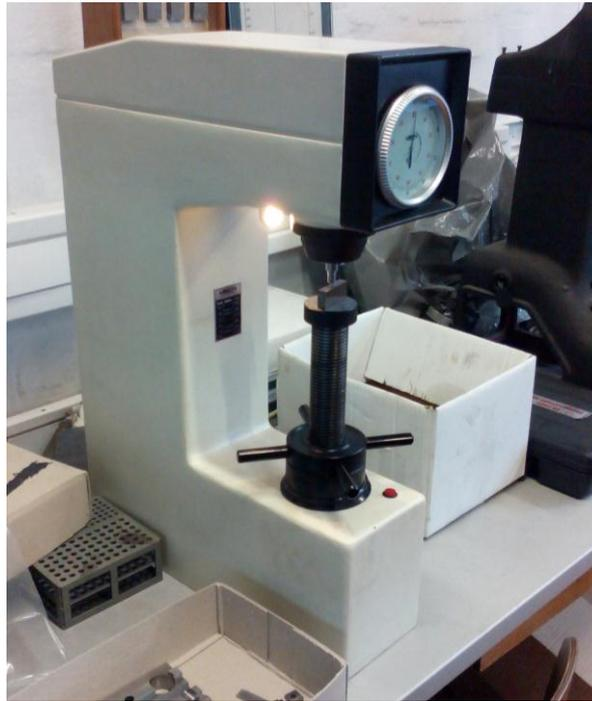
**Slika 3.11** Rocwellov tvrdomjer u laboratoriju za toplinsku obradu FSB-a
