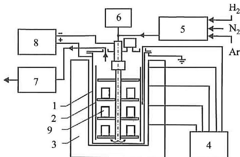
1 – reakcijska komora, 2 – unutarnji kontrolni sustav, 3 –elektrootporna zagrijana retortna peć, 4 – sustav za stabilizaciju i mjerenje temperature, 5 – sustav za kontrolu plina, 6 – mjerna jedinica za kontrolu nastalog sloja, 7 – vakuumski sustav, 8 – napajanje naponom, 9 – osnovni materijal
