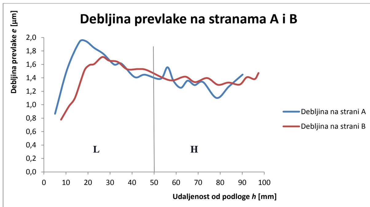
Slika 3.18 Usporedba debljine TiCN prevlake na strani A i B ispitnog uzorka od čelika X37CrMoV5-1
