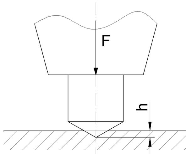
**Slika 3.12** Princip Rockwellovog ispitivanja tvrdoće
