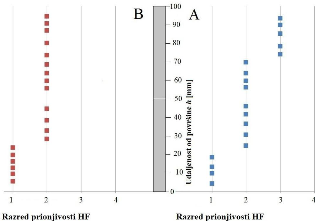
Iz dobivenih dijagrama vidljiva je promjena u prionjivosti prevlake po visini  $h$ , kao i razlika u orijentaciji uzorka. U oba slučaja, odnosno na obje strane uzorka, do visine  $h \approx 20$  mm prionjivost je izvrsna (razred HF1), bez ikakvih mikropukotina, a pogotovo bez delaminacije same prevlake. Nakon navedene visine, odnosno u području  $h > 20$  mm kvaliteta prevlake pada u drugi razred prionjivosti (HF2), pokazujući manji broj mikropukotina oko otiska, no i dalje bez delaminacije.
