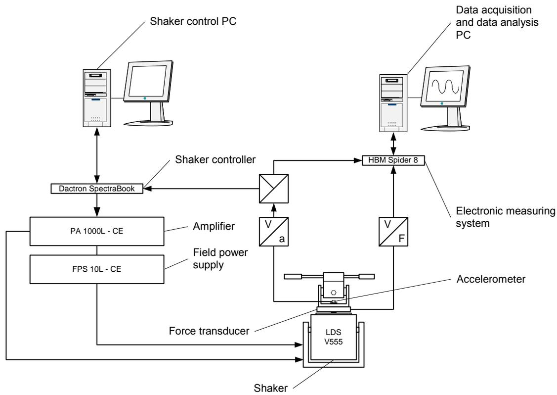
Slika 19. Shema kontrole vibratora i mjerenja
