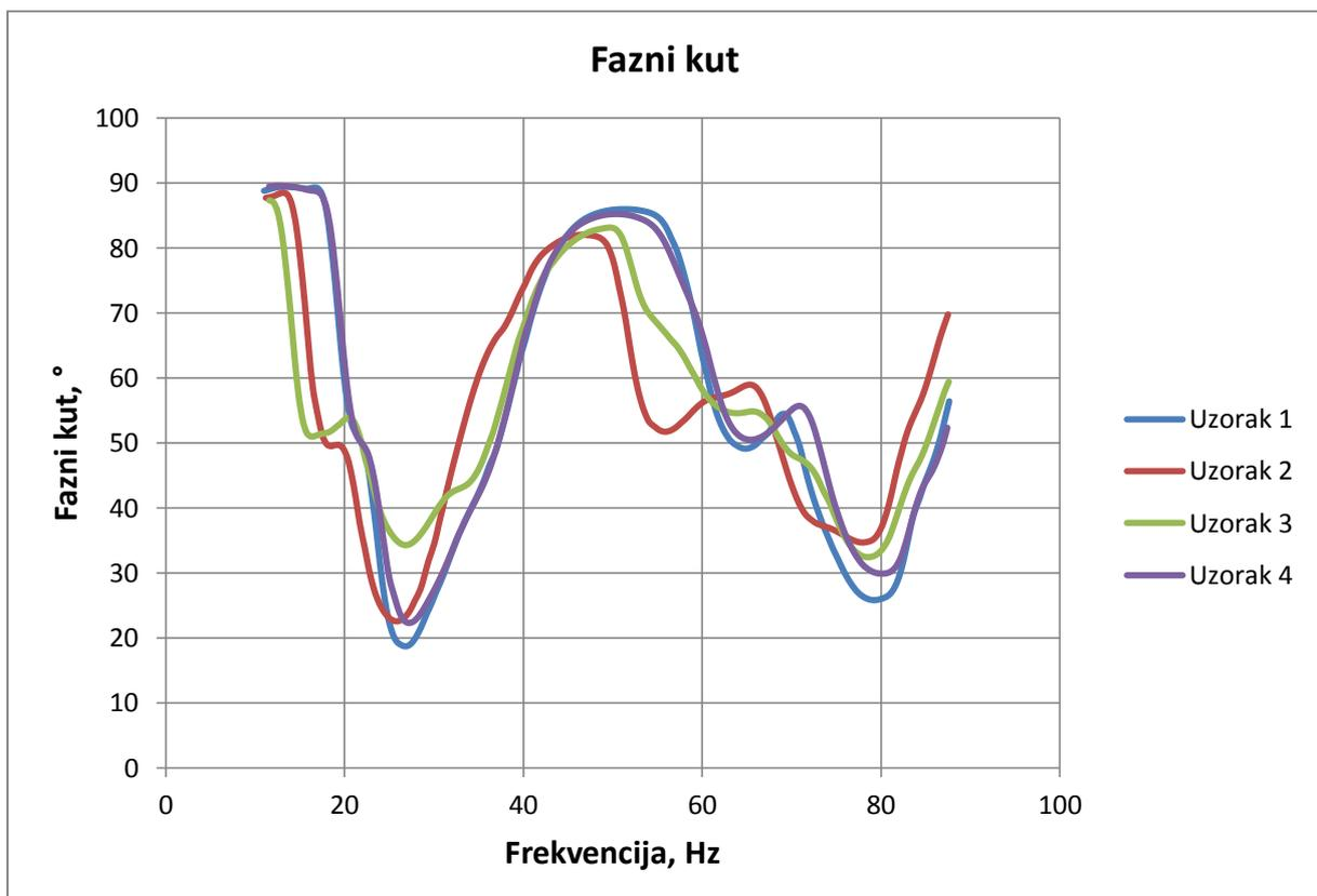
Slika 22. Eksperimentalno snimljene krivulje faznog kuta ispitnih prigušivača
