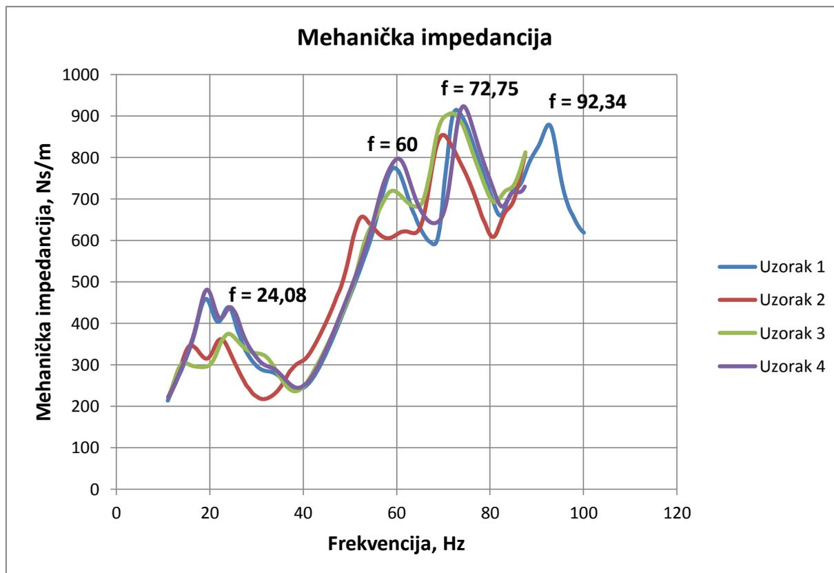
Slika 23. Eksperimentalno snimljene krivulje mehaničke impedancije ispitnih prigušivača
