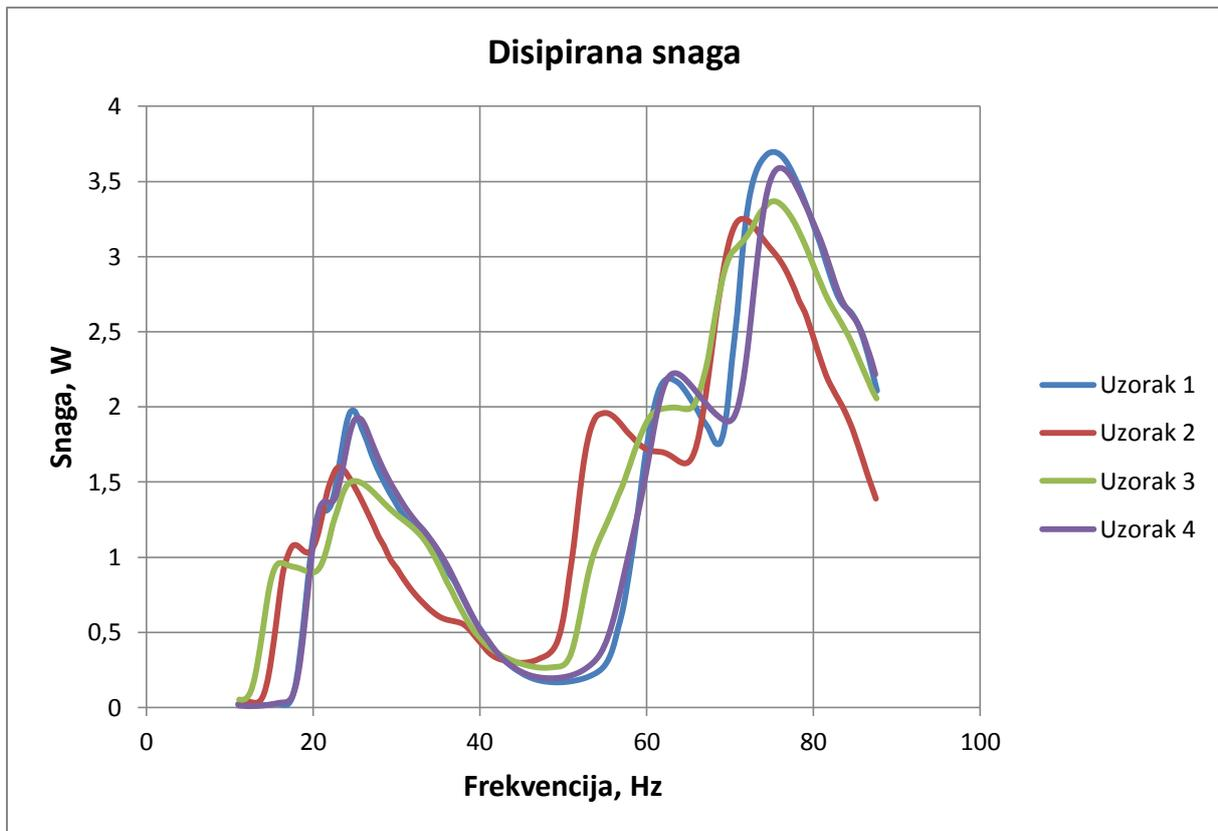
Slika 21. Eksperimentalno snimljene krivulje disipirane snage ispitnih prigušivača
