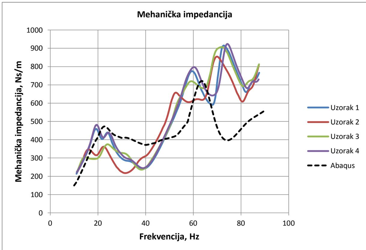
Slika 26. Usporedba mehaničke impedancije
