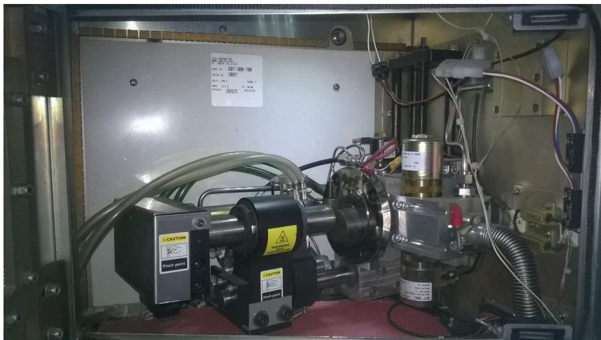
Slika 16. Leco GDS 850A optički spektrometar
