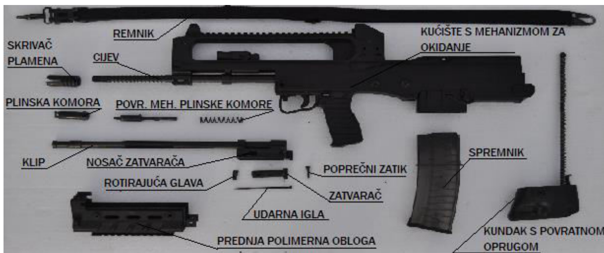
Slika 2. Osnovni dijelovi jurišne puške
