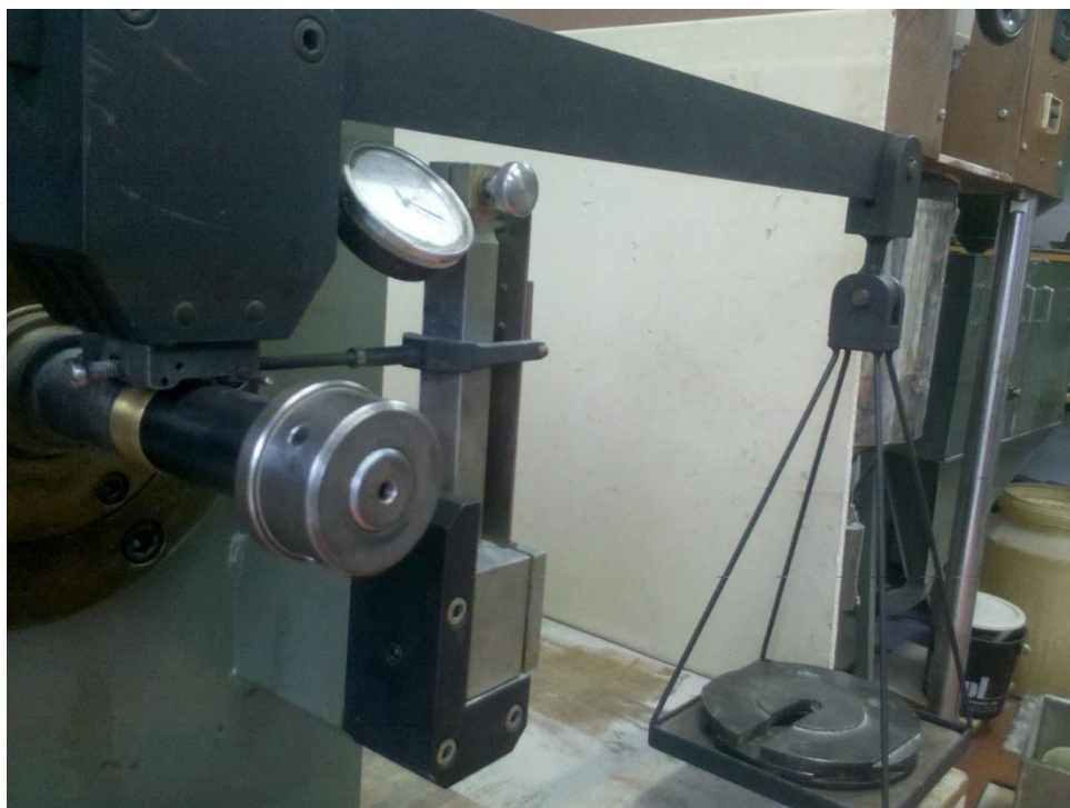
Slika 27. Uređaj za ispitivanje otpornosti na adhezijsko trošenje
