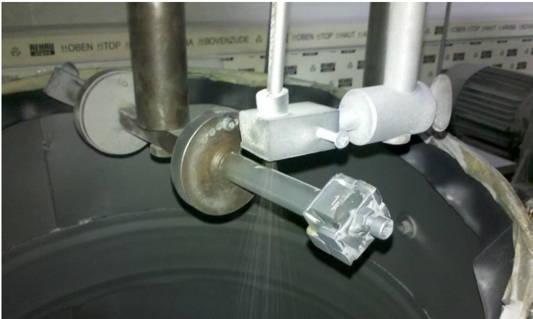
Slika 24. Glava držača sa pričvršćenim uzorkom i sapnica
