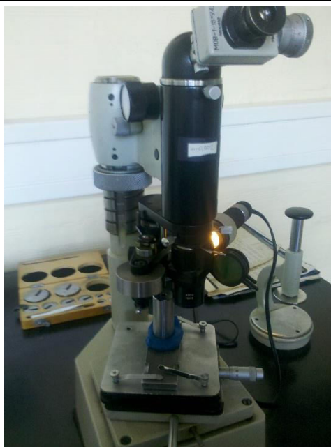
Slika 18. Mjerenje tvrdoće po Vickersu
