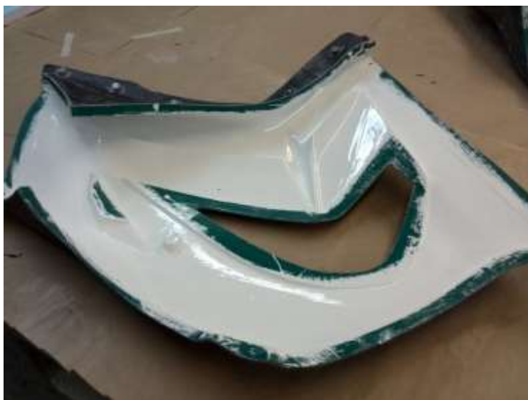
Slika 17. Gelna prevlaka na kalupu stranice motocikla
