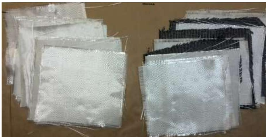
**Slika 27. Slojevi staklenih i ugljičnih ojačanja**
