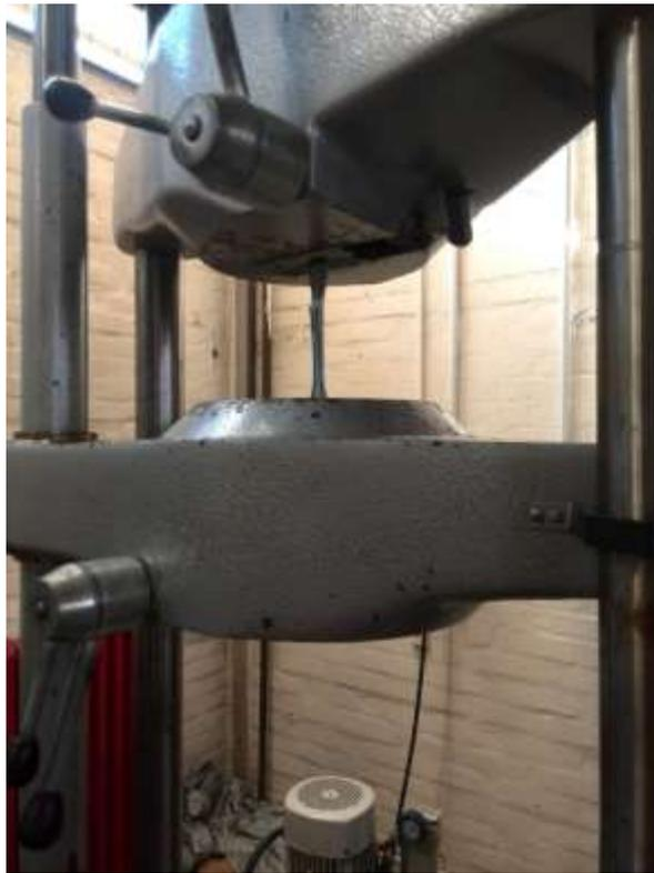
**Slika 31. Statičko vlačno ispitivanje**
