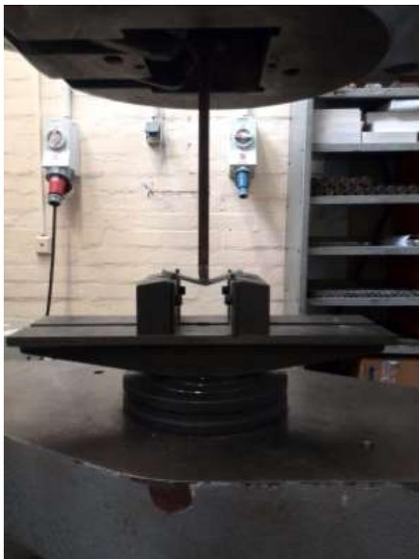
Slika 42. Ispitivanje savojne čvrstoće
