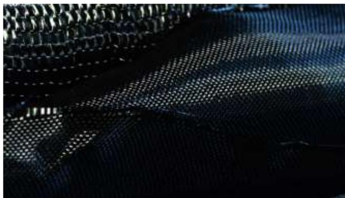
**Slika 10. Ugljična vlakna [13]**
