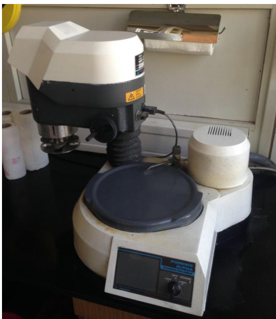
Slika 28 Uređaj za strojno brušenje metalografskih uzoraka
