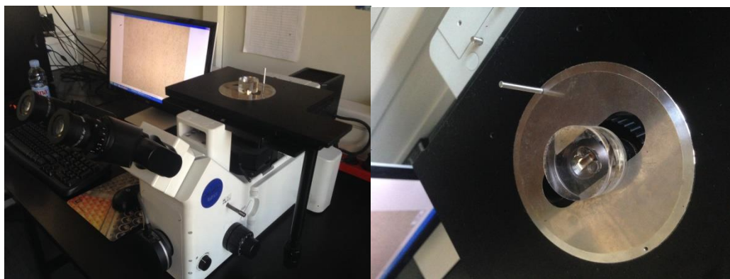
Slika 18 Analiza uzorka na svjetlosnom mikroskopu
