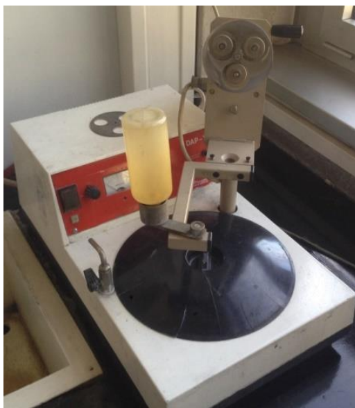
Slika 29 Uređaj za pripremu metalografskih uzoraka poliranjem
