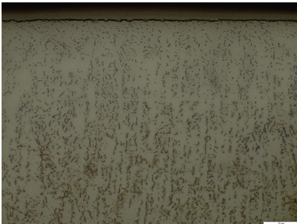
Slika 31 . Rub uzorka plazmatski nitrirane Ti6Al4V legure na svjetlosnom mikroskopu pri povećanju 1000:1
