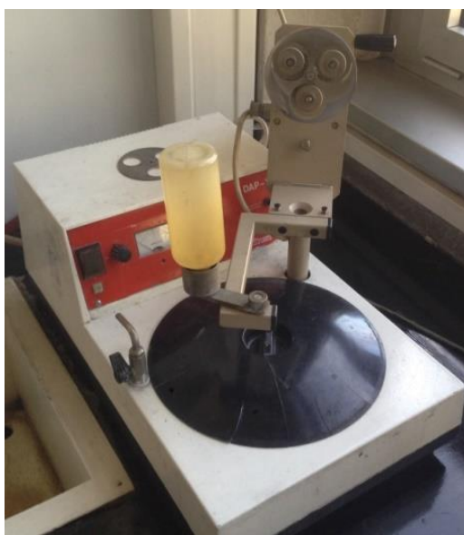
Slika 29 Uređaj za pripremu metalografskih uzoraka poliranjem
