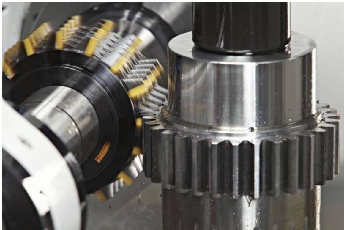
Slika. 16. Odvalno glodanje zupčanika [17]
