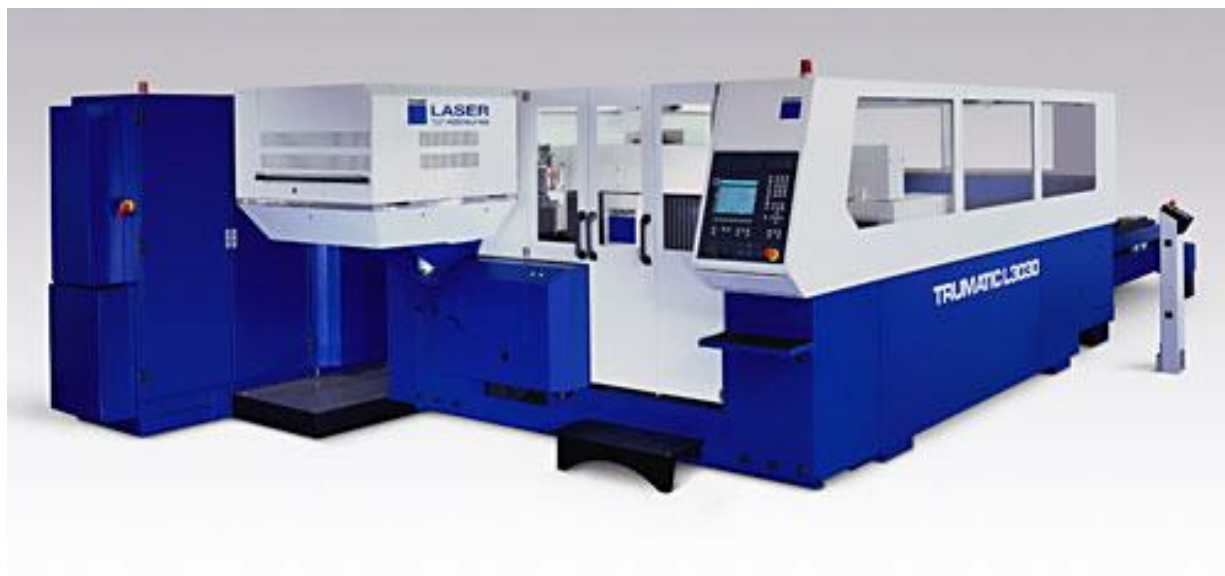
Slika. 19. Laser za rezanje limova Trumpf Trumatic L3020 [21]
