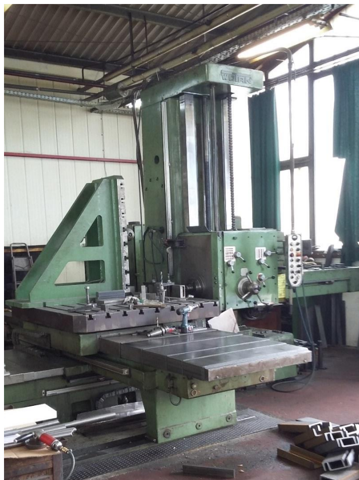
Slika. 23. Horizontalna glodalica bušilica B130S ILR [21]
