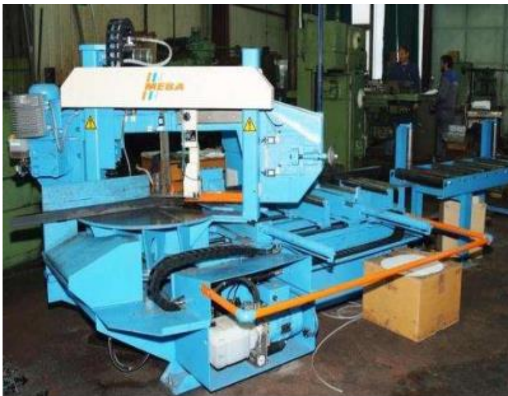
Slika. 20. CNC tračna pila Meba 335 DGA 1000 [21]
