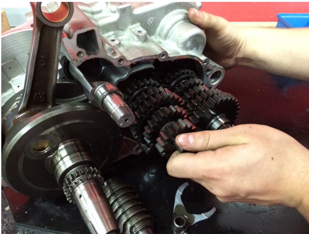
Slika 7. Serijski mjenjač proizvođača Husqvarna
