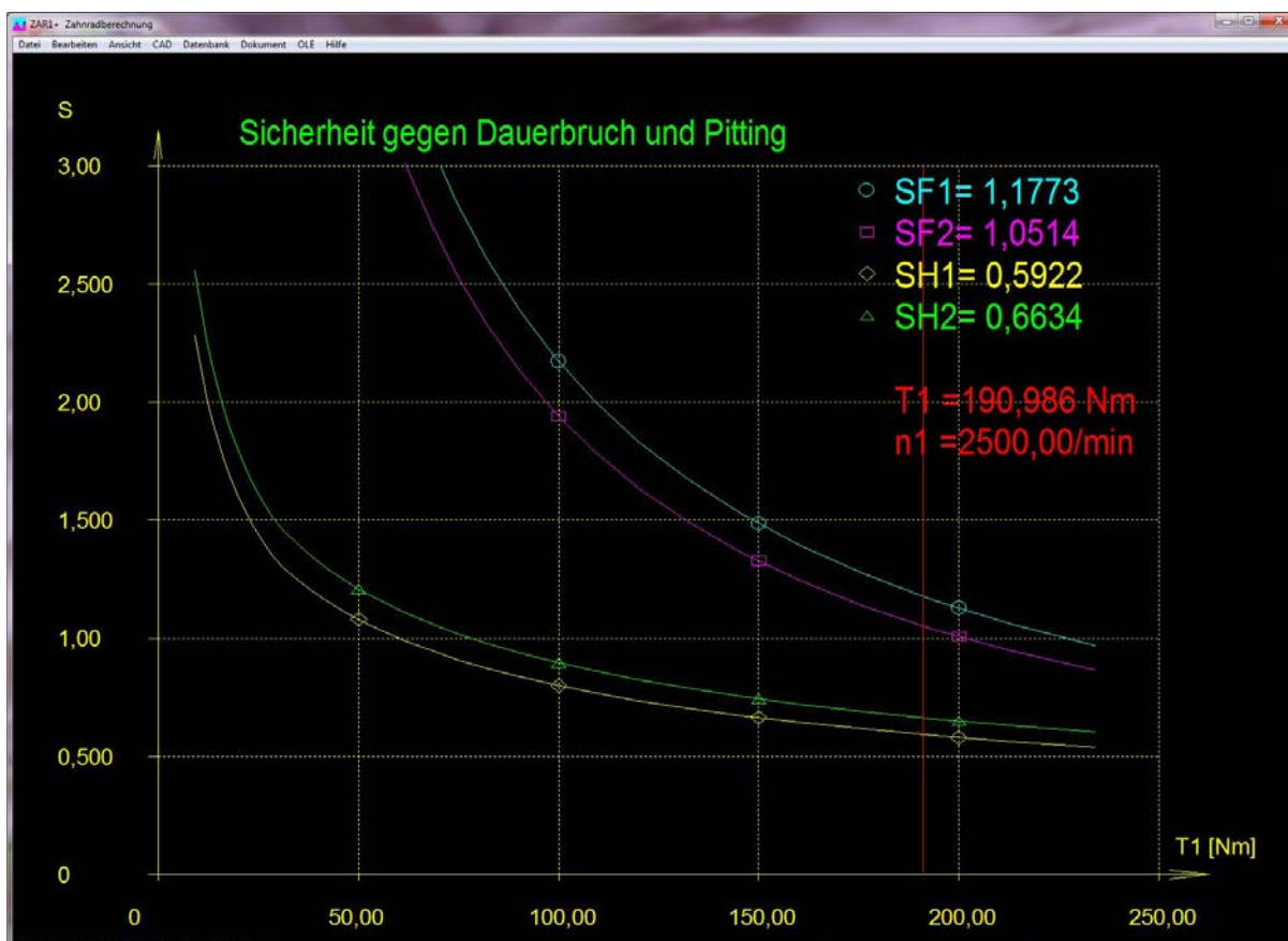
Slika 15. Sigurnost na savijanje zuba, osovinska redukcija
