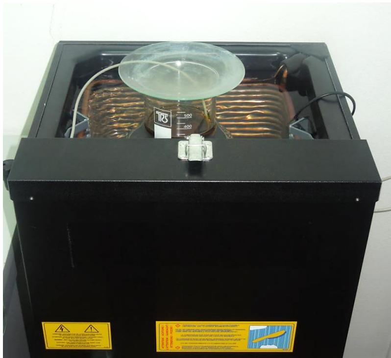
Slika 22. Provodenje ispitivanja u vodenoj kupelji
