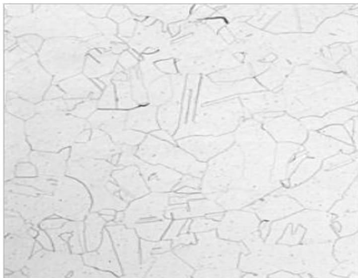
**Slika 2. Mikrostruktura austenitnog nehrđajućeg čelika [6]**
