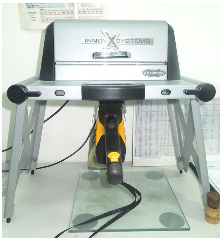
Slika 21. XRF uređaj za provjeravanje kemijskog sastava materijala
