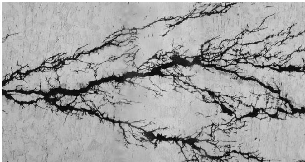
Slika 8. Napetosna korozija [3]
