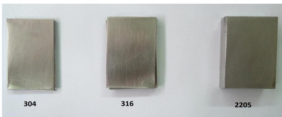
Slika 18. Ispitni uzorci nehrđajućih čelika
