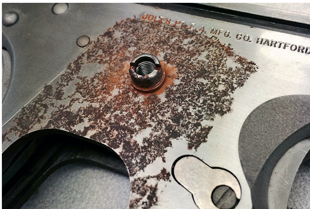
Slika 7. Rupičasta korozija Colt pištolja od nehrđajućeg čelika [12]
