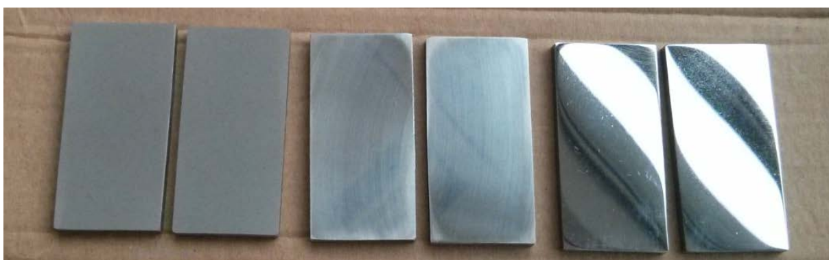
Slika 53. Pjeskareni, brušeni i polirani uzorci
