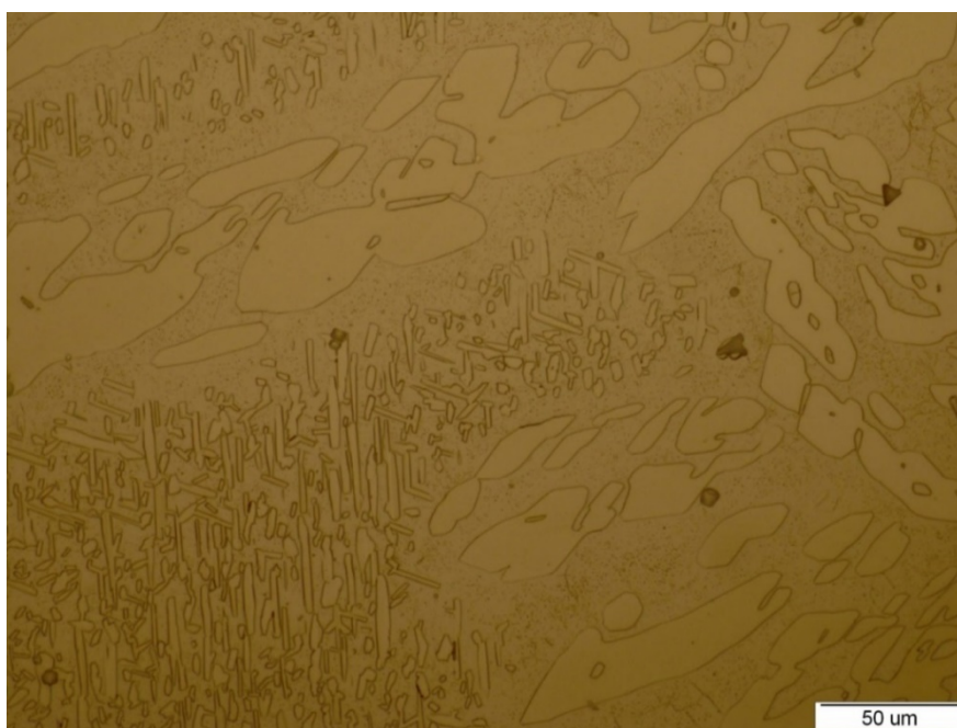
Slika 25. Mikrostruktura dupleks nehrđajućeg čeličnog lijeva
