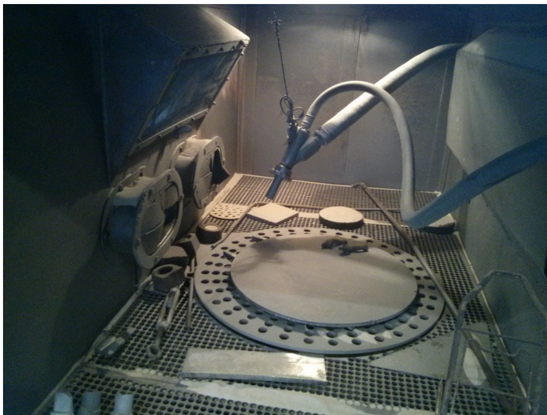
Slika 51. Unutrašnjost uređaja za pjeskarenje
