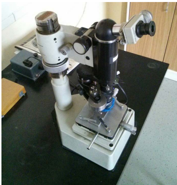
Slika 47. Mikrotvrdomjer po Vickers metodi PMT-3
