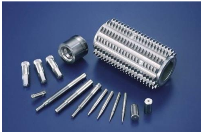
Slika 15. Alati prevučeni prevlakom TiCN [13]
